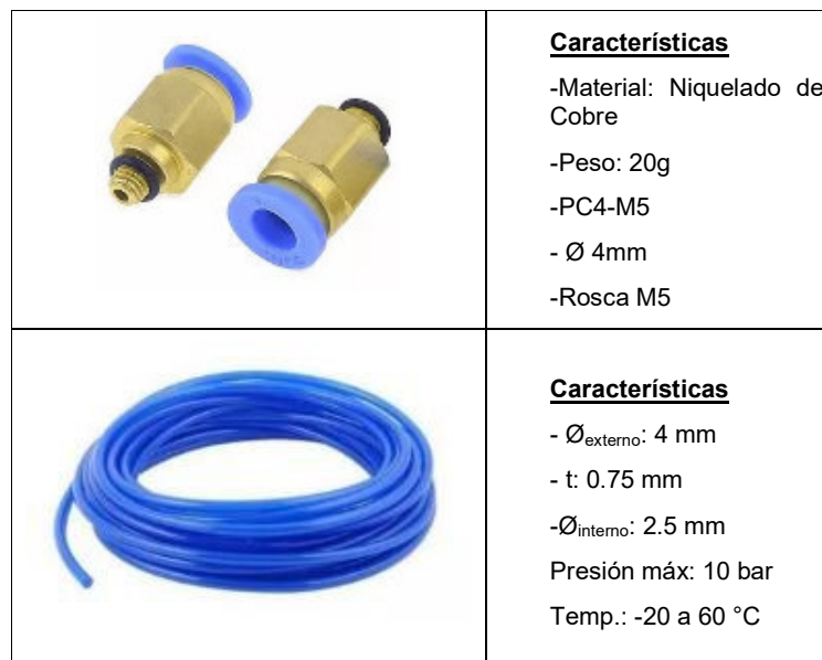
Fig. 89. Conexiones y manguera para manómetro ( https://articulo.mercadolibre.com.ar/MLA-659738997-conector-neumatico-recto-4mm-con-rosca-m5-impresora-3d- JM )
