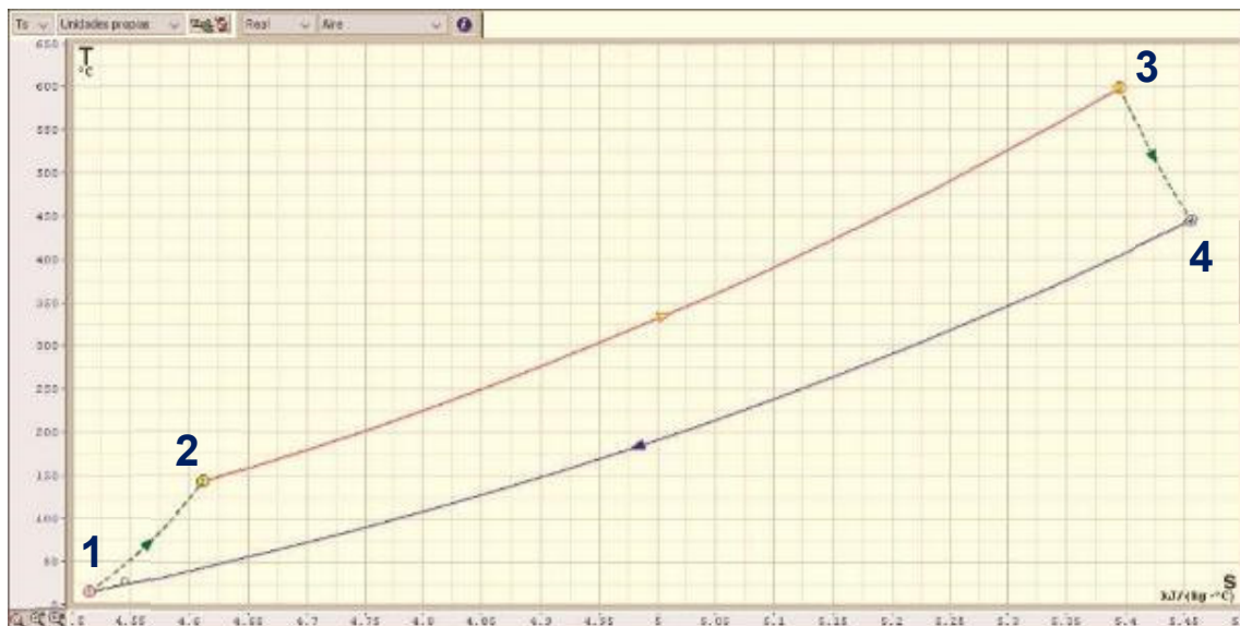
Fig. 14. Diagrama T-S del Ciclo Termodinámico adoptado. T_3= 600^{\circ}\text{C} , \eta_{iT} = 0.8 , \eta_{iC} = 0.7 .
