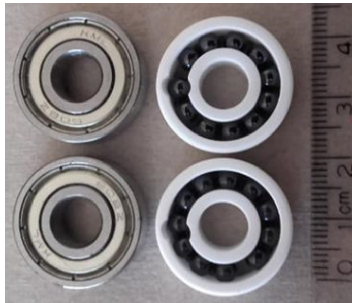
Fig. 79. Rodamientos de acero (izquierda) y cerámicos (derecha) adquiridos para el prototipo y montaje final de la turbina, respectivamente.
