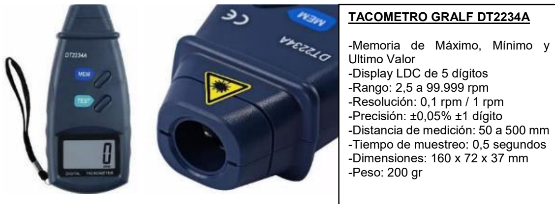
Fig. 91. Características del Tacómetro digital GRALF DT2234A para control de velocidad de giro. ( https://articulo.mercadolibre.com.ar/MLA-695130715-tacometro-digital-laser-sin-contacto-gralf-dt2234a-rpm-funda-JM )
