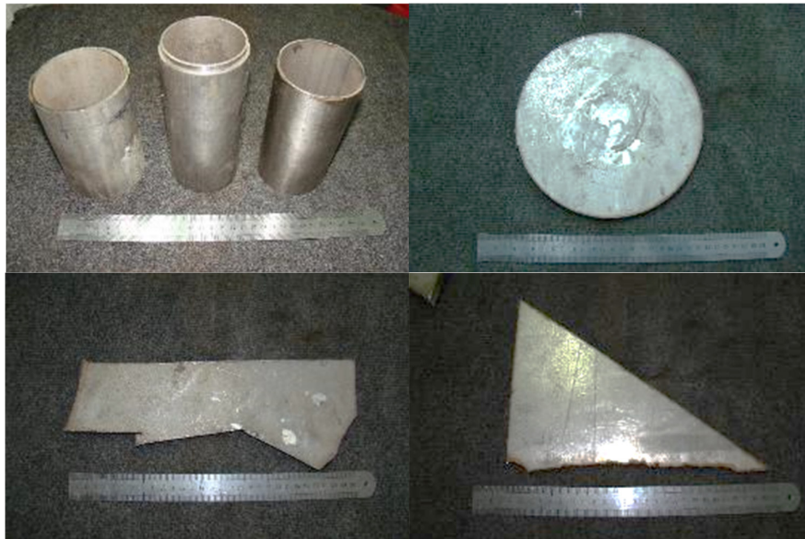
Fig. 56. Muestras de material AISI 304 destinadas a la construcción de la etapa de turbina.
