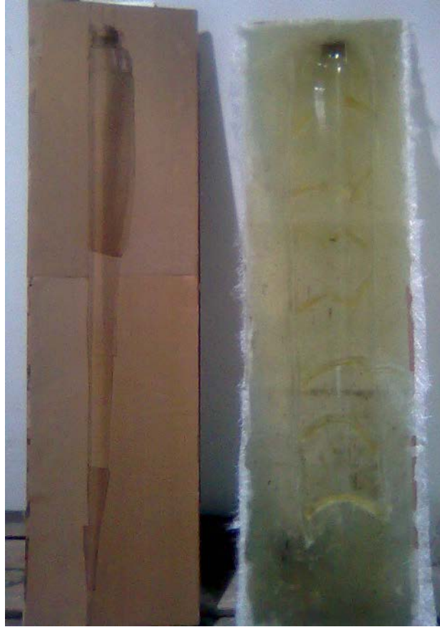
Figura 5.14 – Izquierda – Contramolde 2 (izquierda), molde 2 (derecha).
