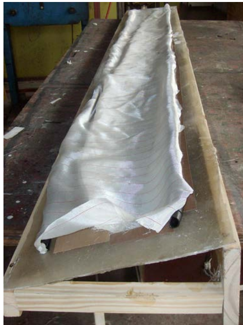
Figura 6.4 – Peel ply sobre los canales y las fibras.
