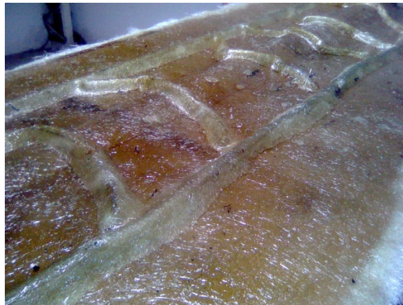
Figura 5.15 – Refuerzos del molde.
