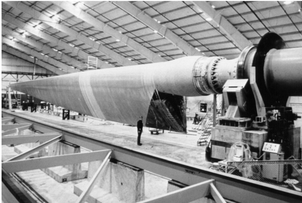
Figura 1.12 – Aspa de la turbina WTS-3 sobre la máquina de filament winding .
