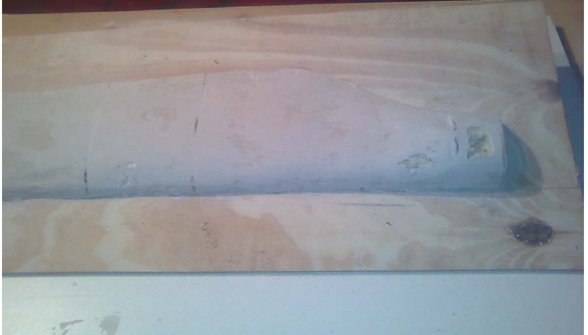
Figura 5.6 – Remasillado del contra molde 1.
