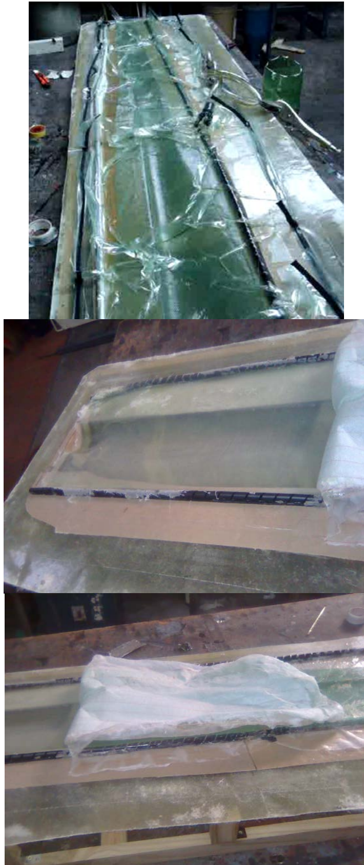
Figura 6.8 – Secuencia de fabricación de la cara inferior.
