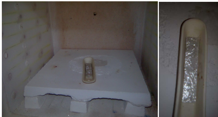
Figura 2.5 – Mufla (izquierda), probeta calcinada (derecha).
