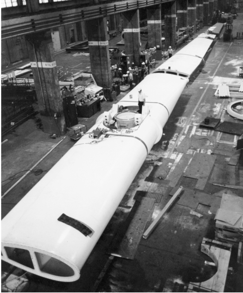
Figura 1.7 – Aspa Completamente de acero de la turbina experimental Americana MOD-2.
