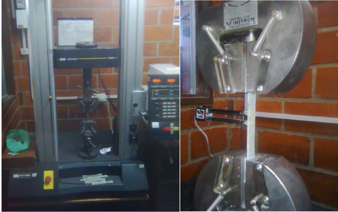
Figura 2.8 – Maquina de ensayos INSTRON (izquierda), extensómetro y mordazas (derecha).
