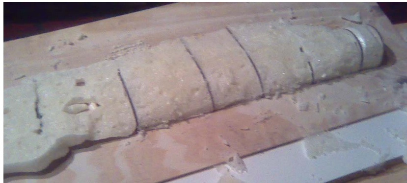
Figura 5.5 – Corte de la espuma, contra molde 1.
