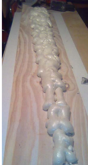
Figura 5.4 – Contra-molde 1 recubierto con espuma de poliuretano.
