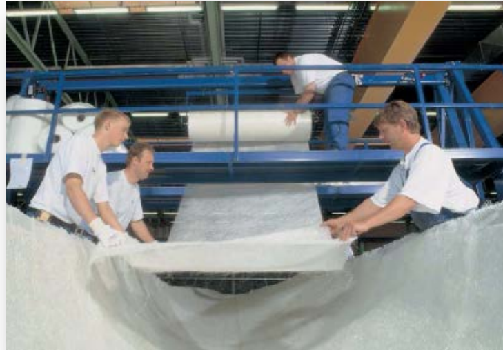
Figura 1.15 –Ubicación del material de refuerzo en el molde.
