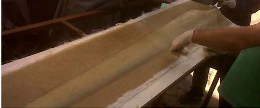
Figura 5.12 – Fibras completamente impregnadas con resina.
