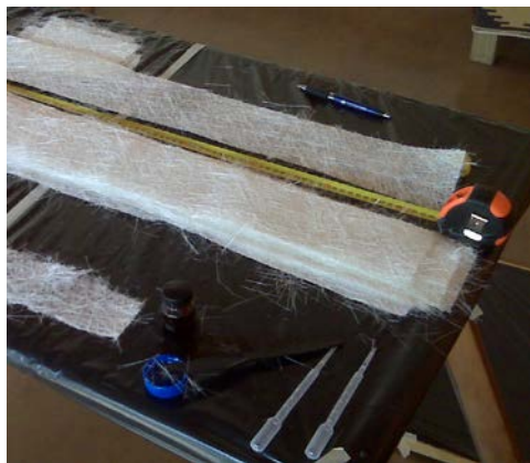
Figura 6.10 – Distribución de láminas de refuerzo.
