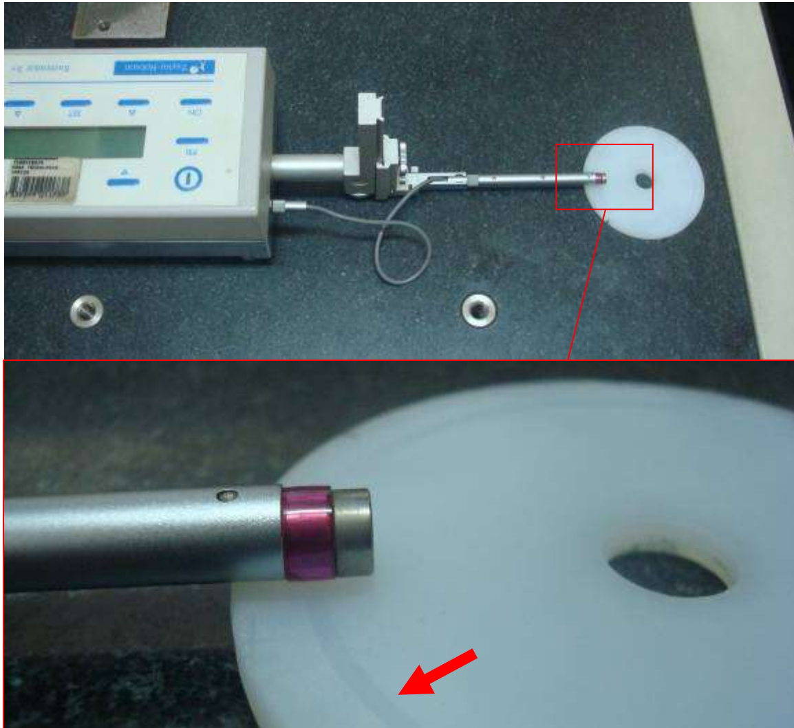
Figura 6.13: Medida de la geometría de la huella con perfilómetro. Se señala la huella
