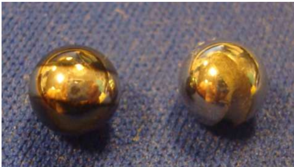
Fig. 6.5: Bolillas: recubierta (izquierda) y sin recubrir (derecha)
