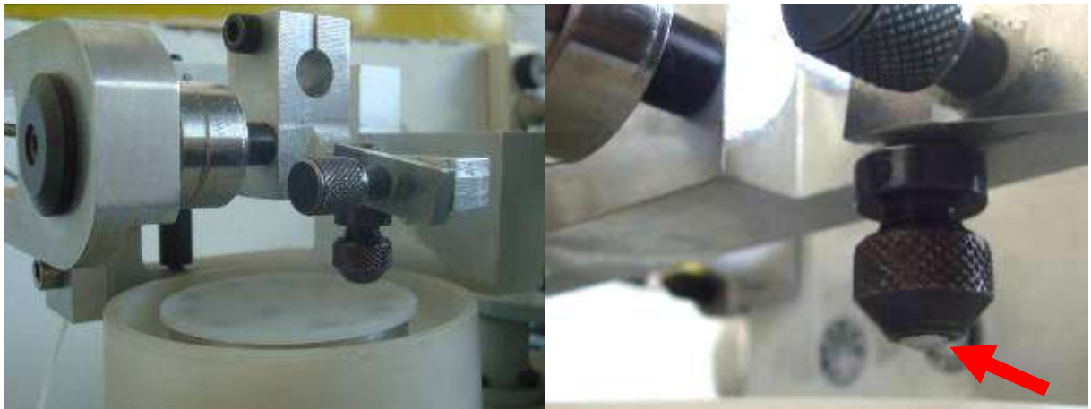
Figura 6.4: Configuración pin bolilla de acero y disco de polietileno
