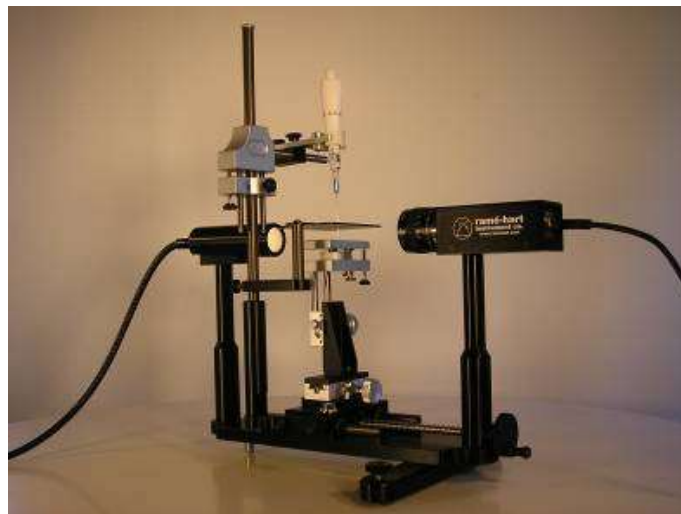
Figura 5.14: Goniómetro Rame Hart utilizado en el estudio
