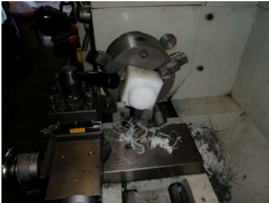
Fig. 6.7: Torneado de los bloques de UHMWPE para la obtención de cilindros
