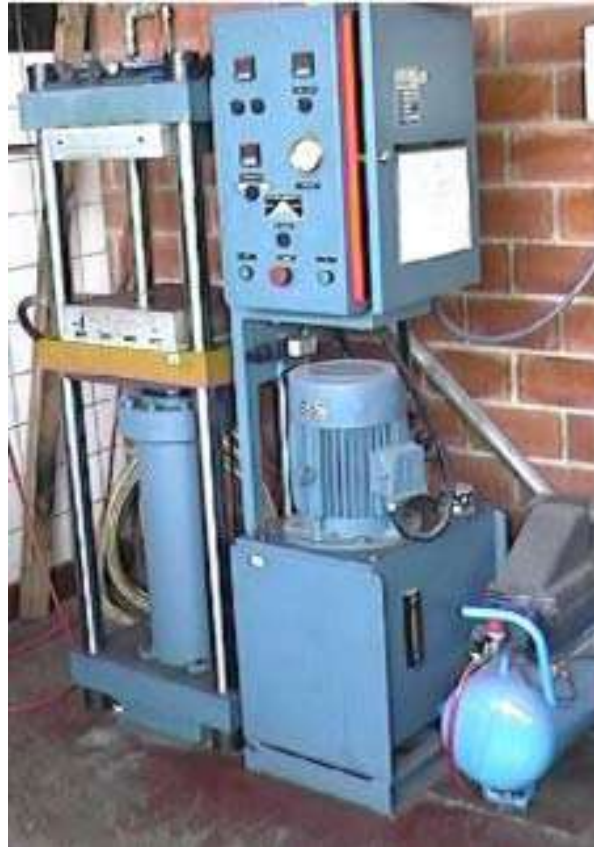
Fig. 6.6: Prensa hidráulica utilizada para el conformado de la placa
