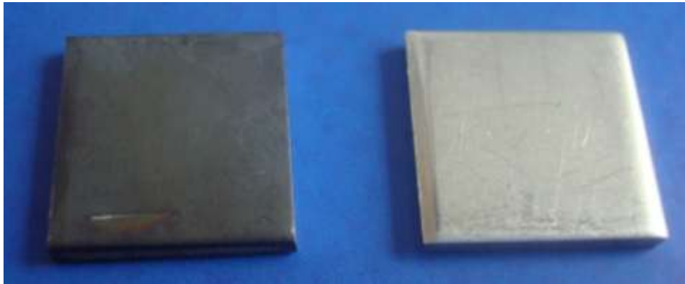
Fig. 5.1: Muestras planas: recubierta (izquierda) y sin recubrir (derecha)
