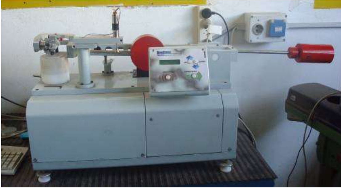
Figura 6.2: Máquina de ensayos de pin-on-disk
