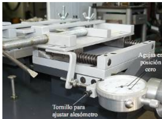
Figura 5.10 A- Sistema de medición de desplazamiento original.
