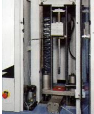
Figura 3.6- Ensayo de impacto tipo Falling Weight.
