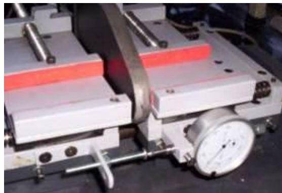
Figura 5.10 B- Modificación del sistema de medición de desplazamiento.
