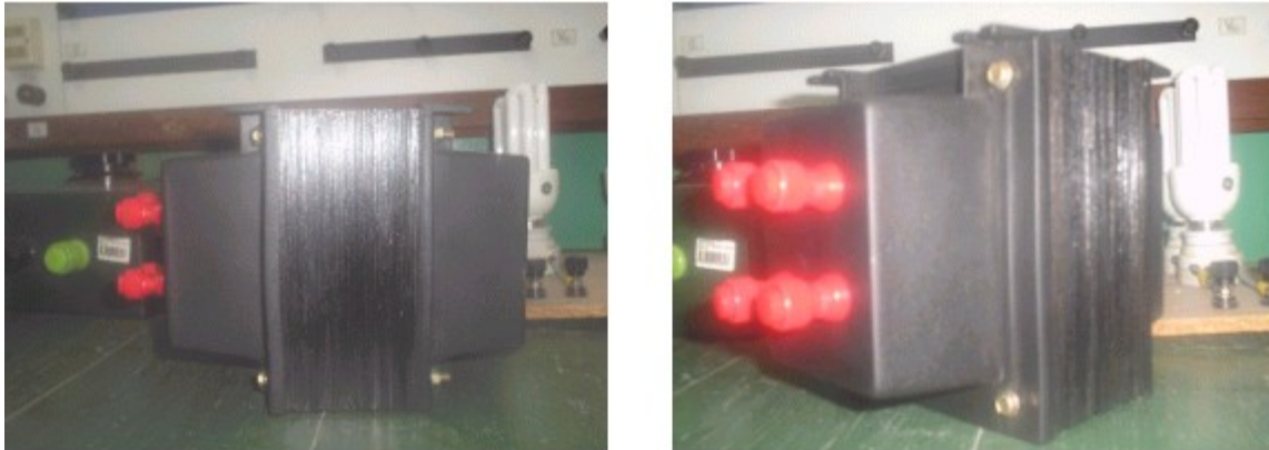
Figura 96-Transformador 220/220V de 1.2KVA.
