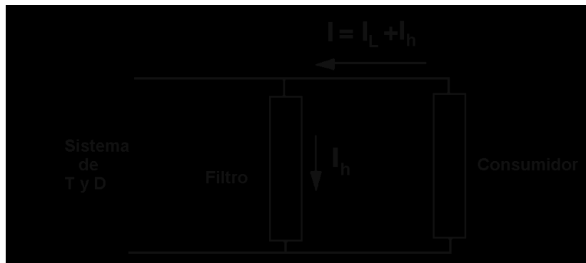
Figura 26[3]- Conexión del filtro activo.
