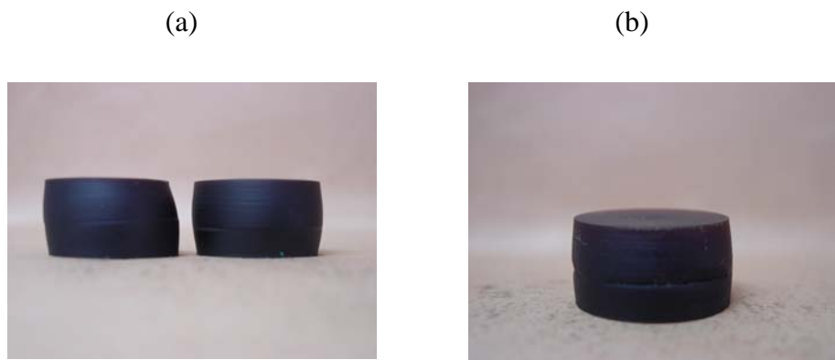
Figura 5.8.: probetas luego de un ensayo de compresión para los sistemas DGEBA/ESO: (a) 100:0 y (b) 40:60.
