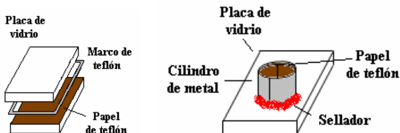
Figura 5.2. Moldes para obtener placas y cilindros.
