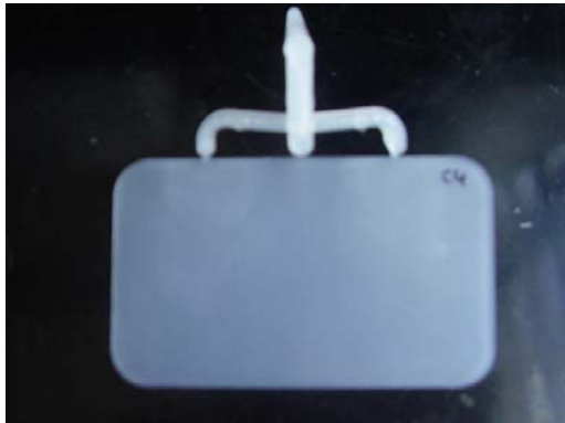
Figura 2.13. c) Presión de inyección 27%.
