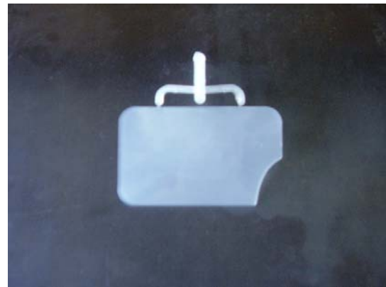
Figura 2.9. Pieza con short shot.
