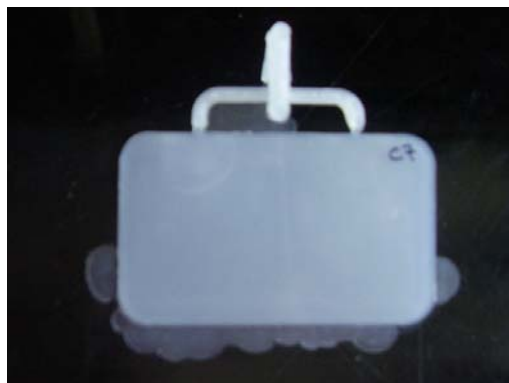
Figura 2.13. f) Presión de inyección 33%.
