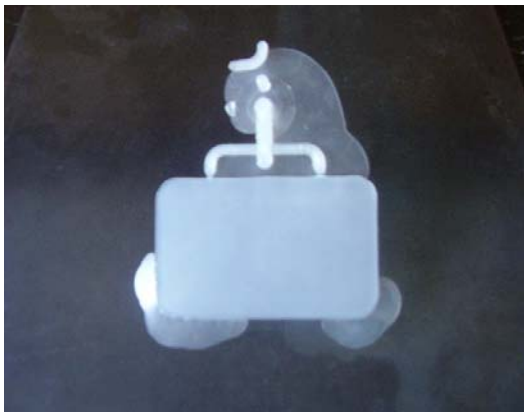
Figura 2.8. Pieza con flashing.
