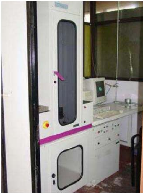
Figura 4.1. a) Máquina de Impacto instrumentado Fractovis Ceast (falling weight); b) Soporte para discos
