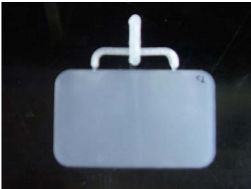
Figura 2.13. d) Presión de inyección 31%.
