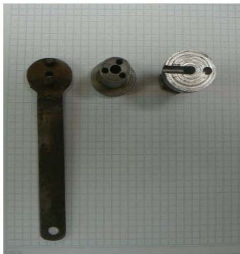
Figura 2.5. Pieza de conmutación y llave diseñada especialmente para la manipulación de ésta pieza.
