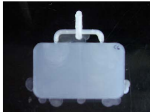
Figura 2.13. e) Presión de inyección 33%.
