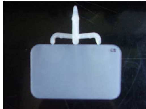
Figura 2.13. d) Presión de inyección 29%.
