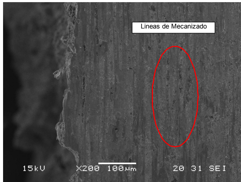
Figura 4-19. Recubrimiento de estaño, superficie lateral.
