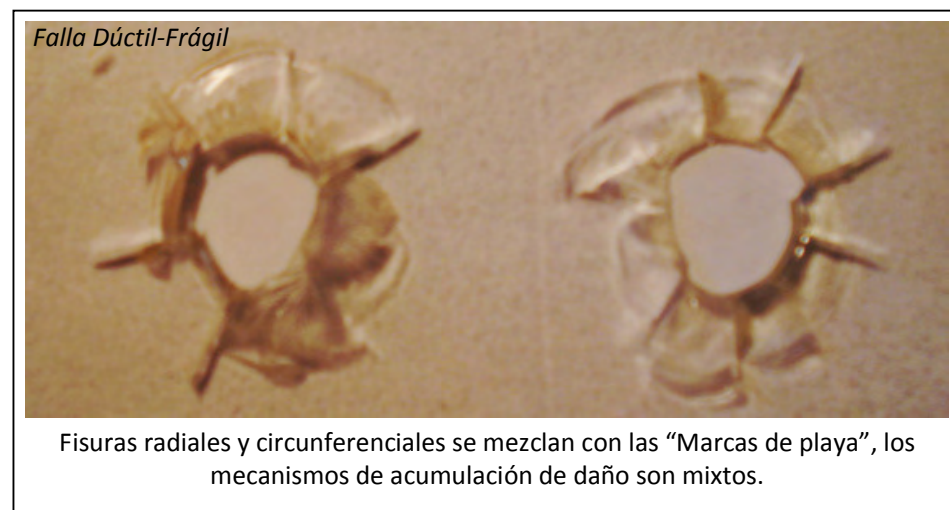
Figura 33: imágenes de las probetas ensayadas por Impacto de DARDO
