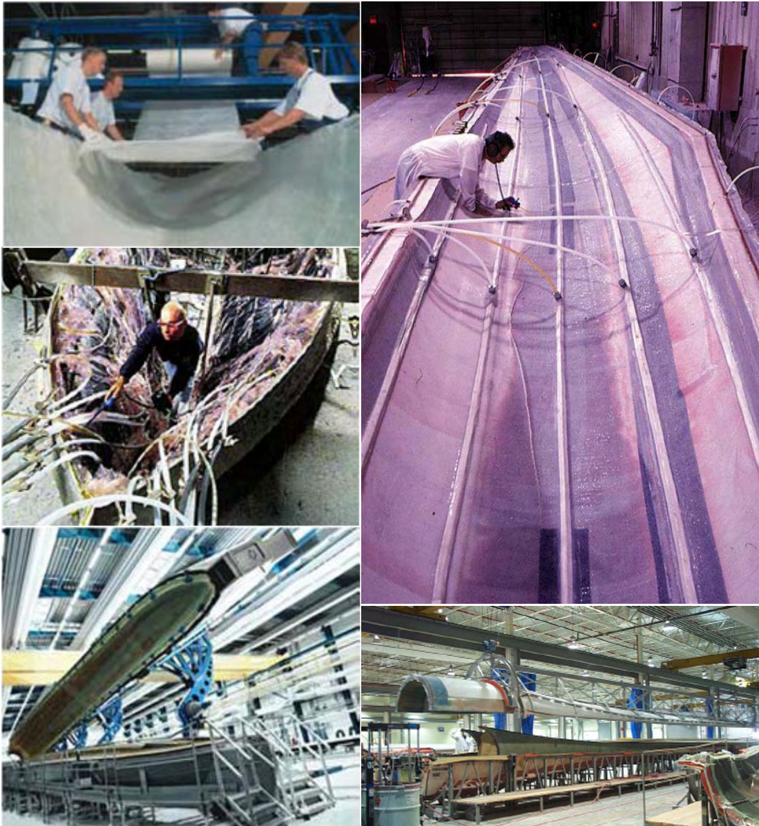
Figura 2: moldes para producir aspas de molinos eólicos bajo la técnica de SCRIMP
