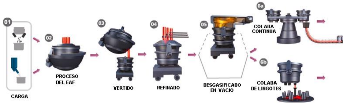
Figura 10. Esquema de los procesos llevados a cabo en la acería.
