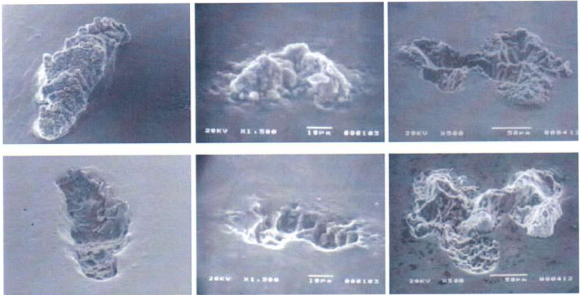
Figura 6.8: Imágenes del contacto correspondiente a electromigración de corriente continua (izquierda), corriente alterna rectificada (centro) y corriente alterna (derecha) [1]
