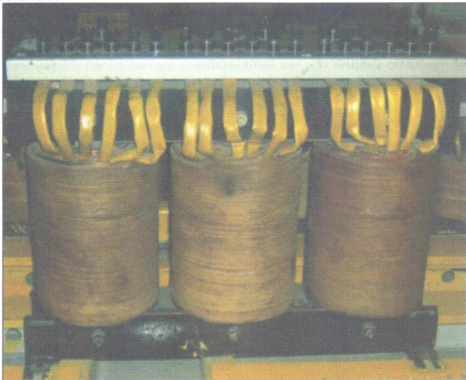
Figura 4.2.1– Transformador de columnas.-
