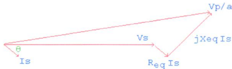
Figura 4.2.7– Diagrama fasorial de un transformador con factor de potencia en retraso.-
