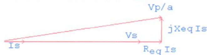
Figura 4.2.8– Diagrama fasorial de un transformador con factor de potencia unitario.-
