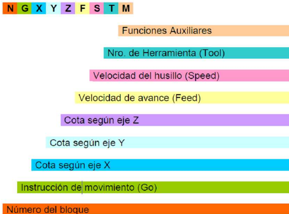
Figura 3.4.14 – Estructura de un bloque de programación CNC, ISO 6983
