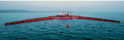
Dispositivos de Sobrepasso: Estructuras que capturan agua en un embalse, que luego se libera para accionar turbinas.
