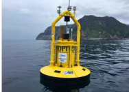
Absorbedores Puntuales: Estructuras flotantes que se mueven con las olas.
