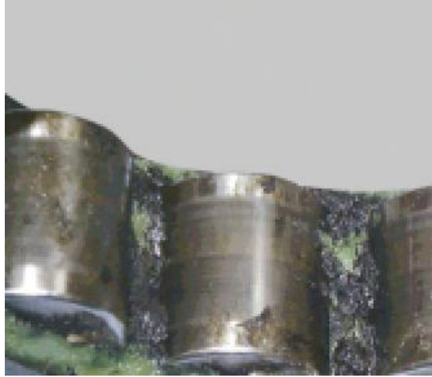
Fig.(9.3). Ennegrecimiento de la grasa. Descargas eléctricas hacen que el aceite base en el lubricante se queme y endurezca creando una condición de lubricación deficiente
