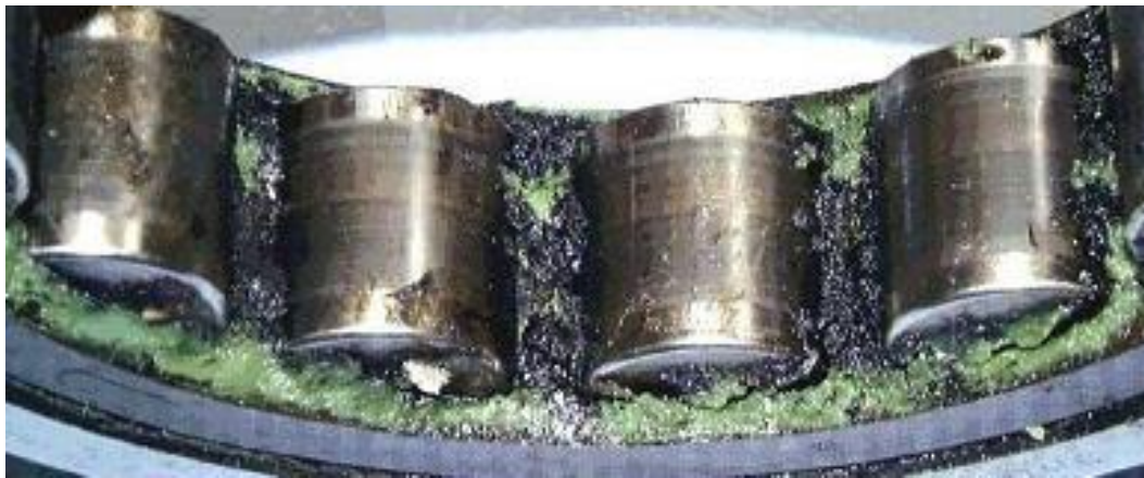
Fig. (1.7) Detección de corrientes de descargas en un motor con rodamientos cilíndricos.[1]
