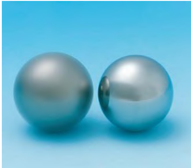
Fig. (9.1). Micro-craterización es el resultado de paso de la corriente eléctrica en los rodamientos. La superficie dañada parece mate y se caracteriza por pequeños cráteres de unos pocos micrones de diámetro.[1]
