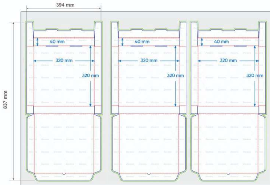
Figura 10. Disposición de cajas para pizza por plancha. Fuente: elaboración propia.
