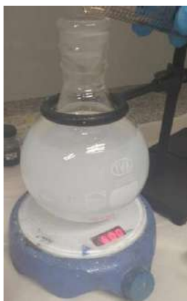
Figura 2.2. Suspensión de nanopartículas de sílice mesoporosa al cabo del proceso de síntesis en medio acuoso alcalino.
