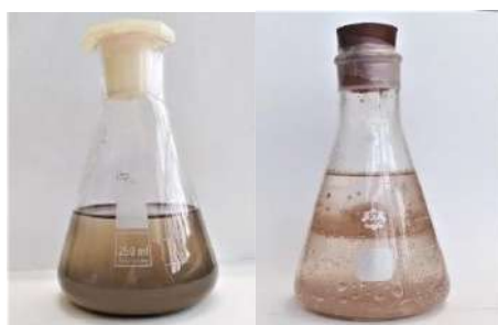
Figura 2.21. Fotografías de los sistemas de síntesis secuencial evaluados. De izquierda a derecha: STE y STA. El STE presentó una coloración ámbar, evidenciando la reducción de plata iónica. En el STA se aprecia un sistema bifásico en una fase de tolueno y otra de agua.
