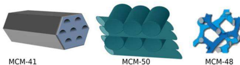
Figura 1.3 Estructuras correspondientes a las diversas nanopartículas mesoporosas de la familia M41S. 20
