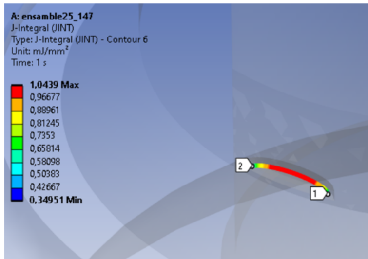
Figura 4.58: Fisuras correspondientes a una tensión de 200 MPa y 65 % de profundidad máxima admisible
