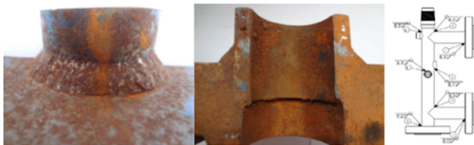
Figura 3.7: Secciones de corte para metalografía (izquierda) y muestras cortadas (derecha).
