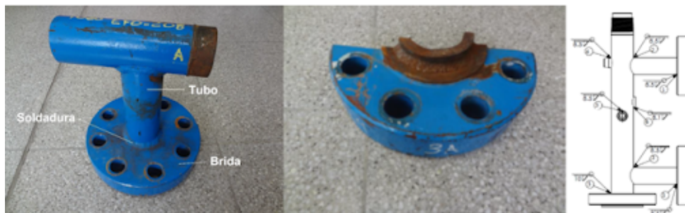
Figura 3.6: Secciones de corte para metalografía (izquierda) y muestras cortadas (derecha).
