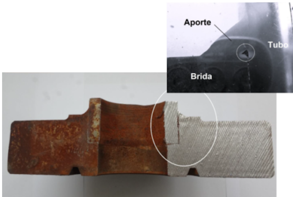
Figura 3.9: Detalle de sección transversal que ilustra un defecto en raíz, inducido por falta de fusión.
