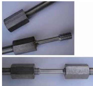
Figura 6.6. Fotografías de celda de carga y encastres roscados
