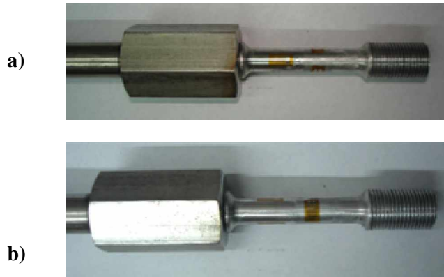
Figura 6.7. Fotografía de celda de carga con extensómetros Vista de extensómetros longitudinales Vista de extensómetros transversales
