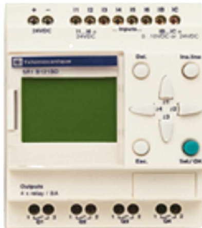
Figura 6.3. Módulo lógico utilizado para automatizar el sistema de carga.
