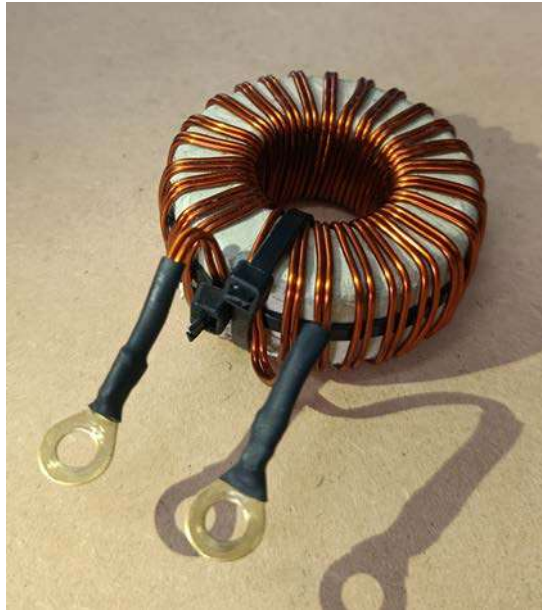
Figura 3.7: Fotografía del inductor construido con el núcleo T250-18 y 26 vueltas de cobre esmaltado AWG 15.
