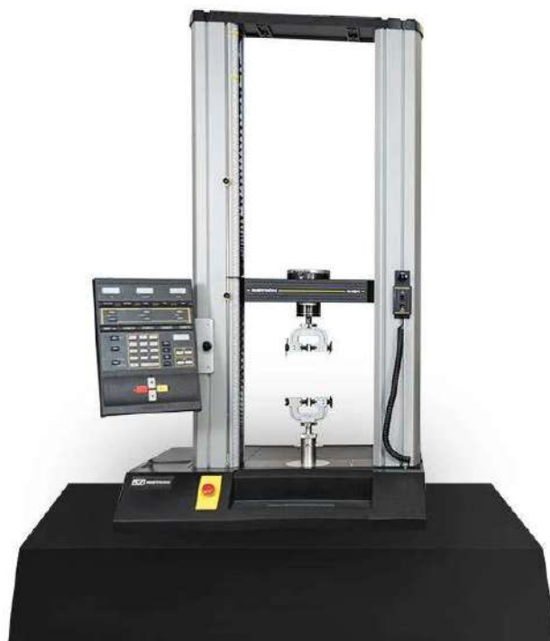
Figura 2: INSTRON Universal Tensile Testing Machine SERIE 4467.
