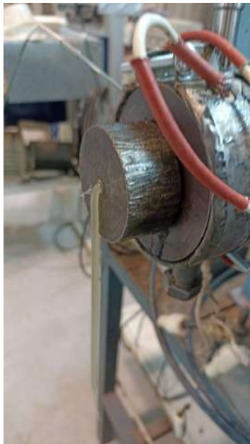
Figura 6: Extrusión del material
