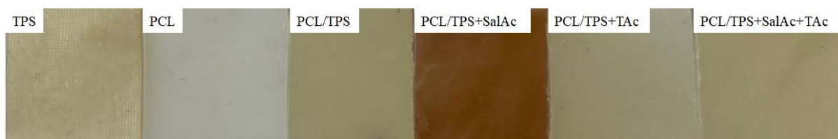
Figura 8. Apariencia de las películas a base de: almidón termoplástico (TPS), poli( \epsilon -caprolactona) (PCL), PCL/TPS, PCL/TPS + ácido salicílico (PCL/TPS+SalAc), PCL/TPS + ácido tartárico (PCL/TPS+TAc) y PCL/TPS+SalAc+TAc.
