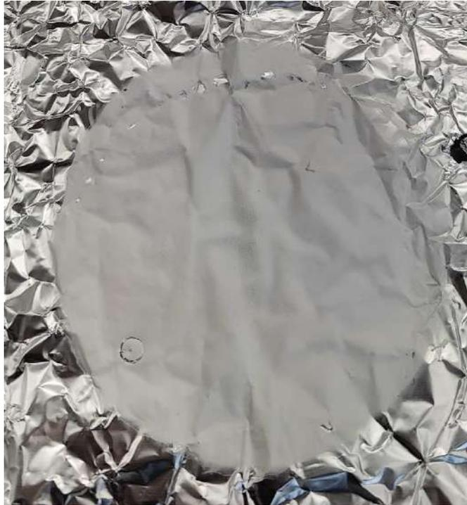
**Figura 23:** Membrana nanofibrosa de PCL, solvente ácido acético y caudal 0.6 mL/h.
