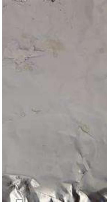
**Figura 38:** Membrana nanofibrosa de PCL, solvente ácido acético y spray de NPs ZnO.
