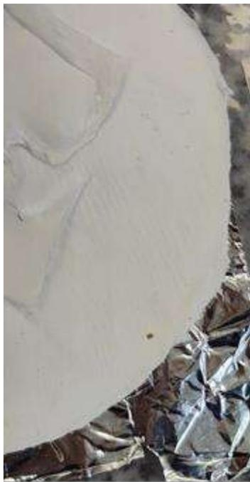
**Figura 39:** Membrana nanofibrosa de PCL, solvente cloroformo-metanol 1:1 y spray de ZIF-8.
