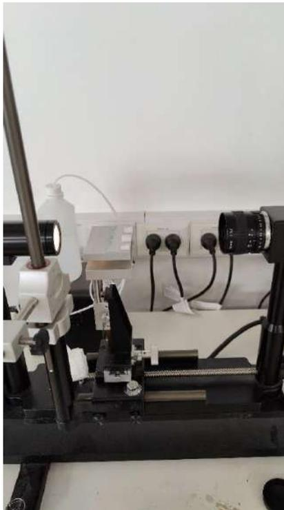
**Figura 13:** Goniómetro y cámara para ensayo de ángulo de contacto.
