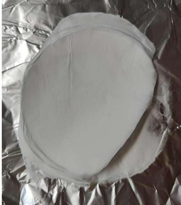
**Figura 24:** Membrana nanofibrosa de PCL, solvente cloroformo-metanol 1:1 y caudal 3 mL/h.
