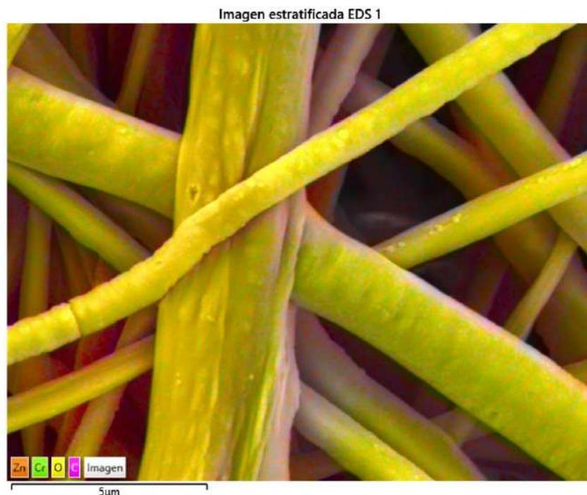
**Figura 50:** Distribución elemental superpuesta, membrana PCL con 5% NPs ZIF-8.
