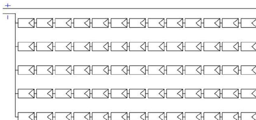
Figura 6.1.1 - Conexionado de módulos fotovoltaicos
