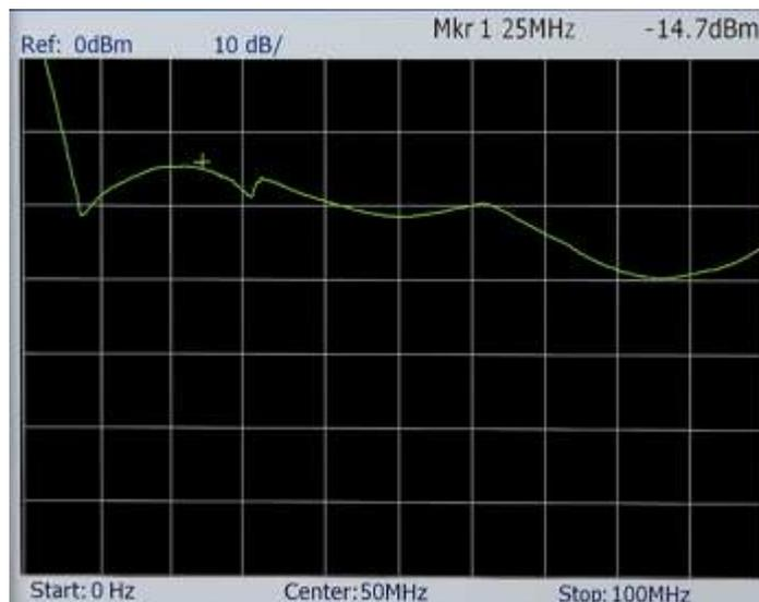
*Figura 3.52. Respuesta en frecuencia de etapa de atenuación (experimental)*
