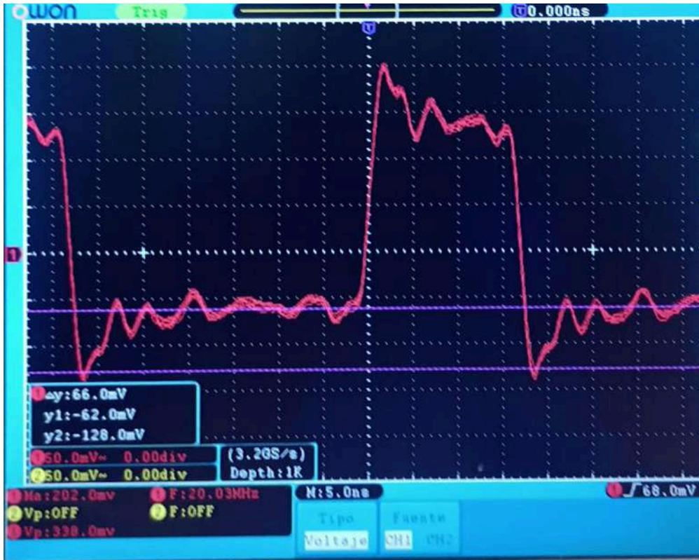
*Figura 3.35. Medición señal de clock (20MHz).*
