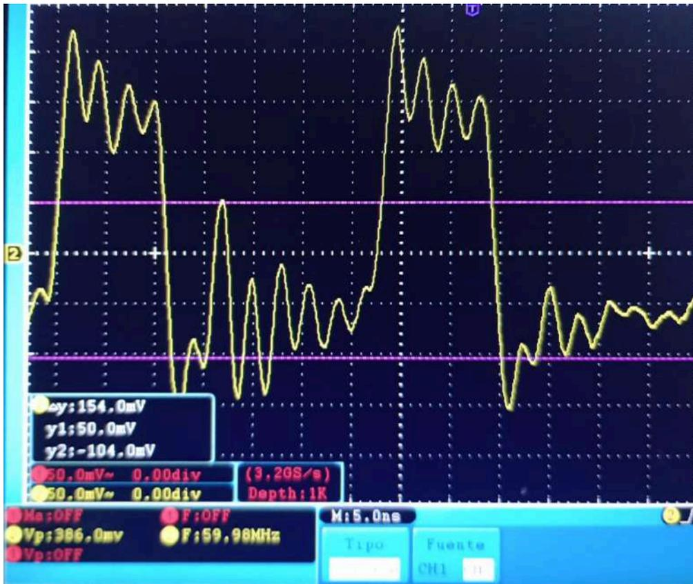
*Figura 3.36. Medición señal de clock(30 MHz).*
