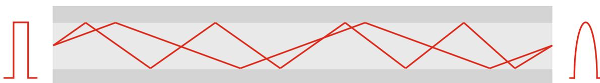
Figura 2.2. Dispersión debida a propagación de diferentes modos.
