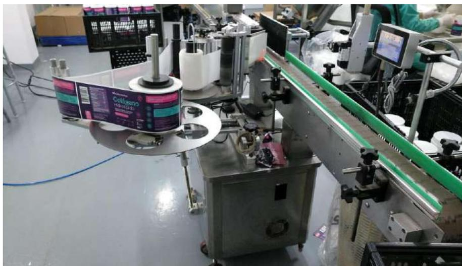
Imagen 8: Máquina etiquetadora.
