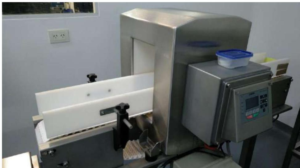
Imagen 6: Máquina detectora de metales.
