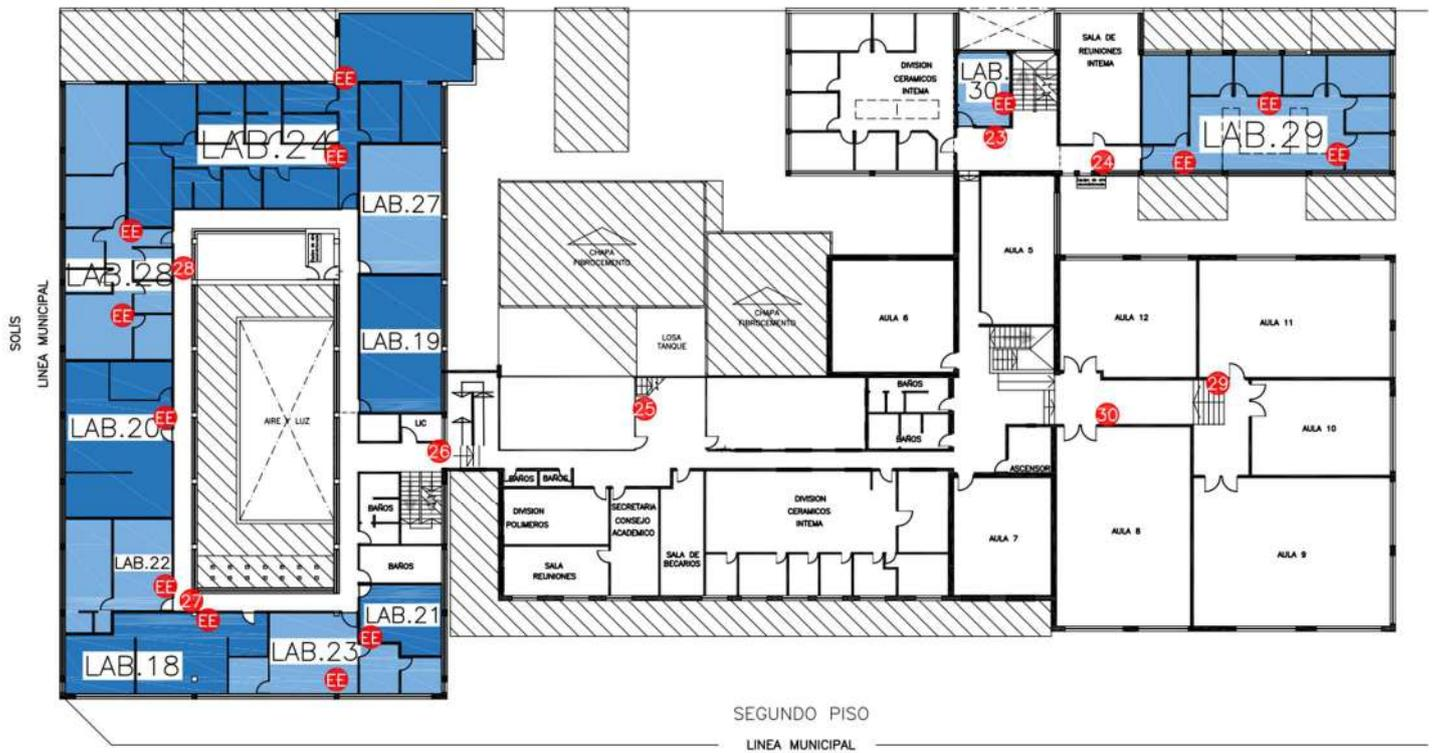
Figura K.4: Extintores portátiles en planta segundo piso.
