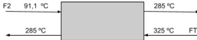
Este equipo tiene involucrada una corriente con una fracción de vapor en todo su recorrido, por lo tanto no puede tratarse de un intercambiador de placas. Debido a que el calor a intercambiar es significativa, no es conveniente utilizar un intercambiador de doble tubo. El equipo más adecuado es uno de tipo tubos y coraza.
