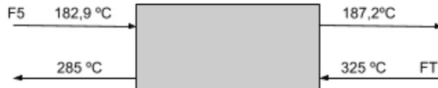
Respecto a los intercambiadores N° 2, 3 y 5, la configuración más adecuada es la de tipo tubos y coraza. Todas estos equipos son los reboilers de las respectivas torres de destilación de cada corriente. En particular, se debe contar con intercambiadores de tipo Kettle.
