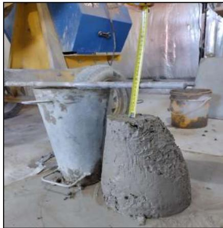
*Figura 2.9. Medida de asentamiento con cono de Abrams*
