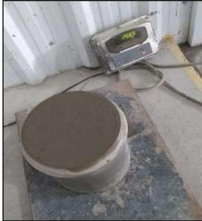
**Figura 2.6.** Recipiente con hormigón para determinar el PUV
