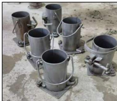
**Figura 2.10.** *Moldes de 10 cm de diámetro y 20 cm de altura*
