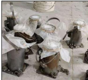
**Figura 2.11.** *Moldes listos cubiertos con plástico*
