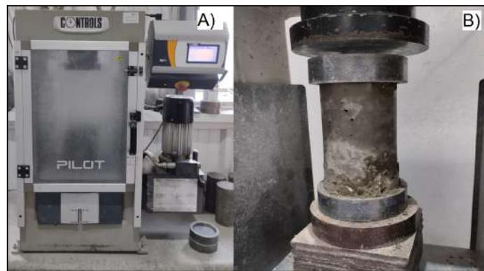
**Figura 2.13.** *Compresión probetas: a) Máquina de ensayos “CONTROLS”; y b) Colocación de probeta para compresión*
