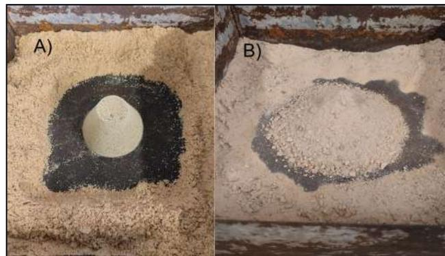
**Figura 2.4.** Agregado fino: a) Condición saturada; y b) Condición SSS
