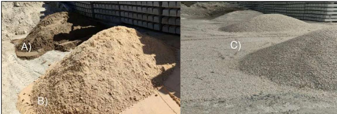
**Figura 2.1.** Acopio de agregados: *a)* Arena de trituración 0/6 C; *b)* Arena fina; y *c)* Piedra cuarcítica 6-20.
