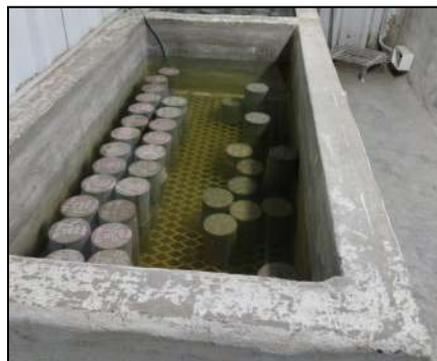
**Figura 2.12.** *Curado de probetas*
