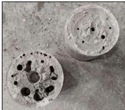
**Figura 2.8.** *Probetas obtenidas del ensayo de tiempos de fragüe*
