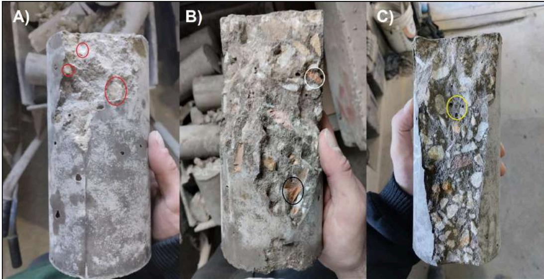
**Figura 4.9.** Tipo de rotura probetas recicladas: a) Tipo 5 - 10%; b) Tipo 4 - 20%; y c) Tipo 4 - 30%
