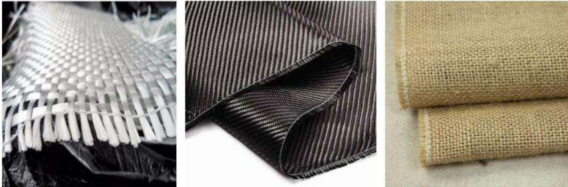
**Figura 1.3.** De izq. a der. Tejidos bidireccionales de fibra de vidrio, carbono y yute.
