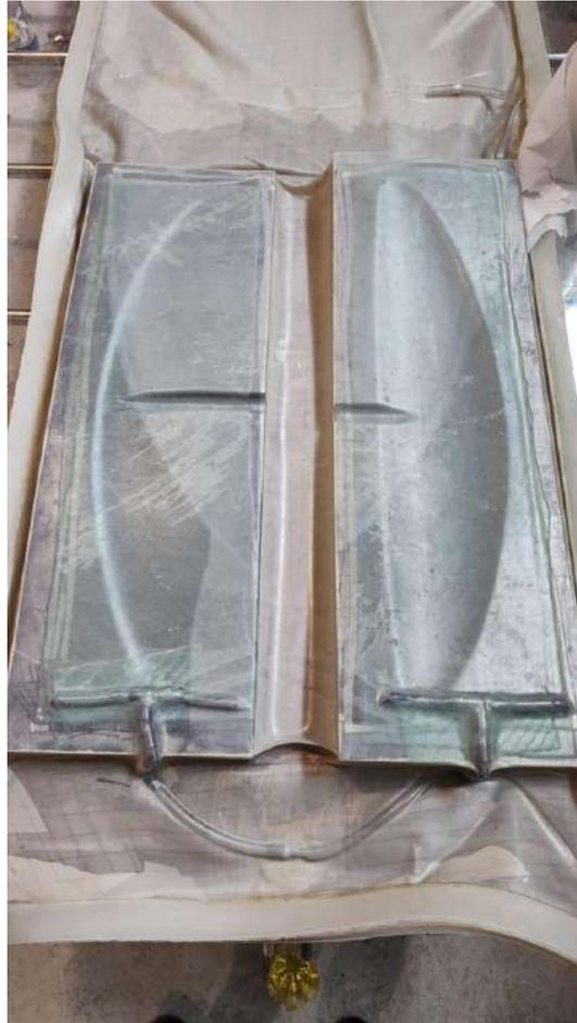
**Figura 5.4.** Pieza en la membrana de silicona post impregnación.
