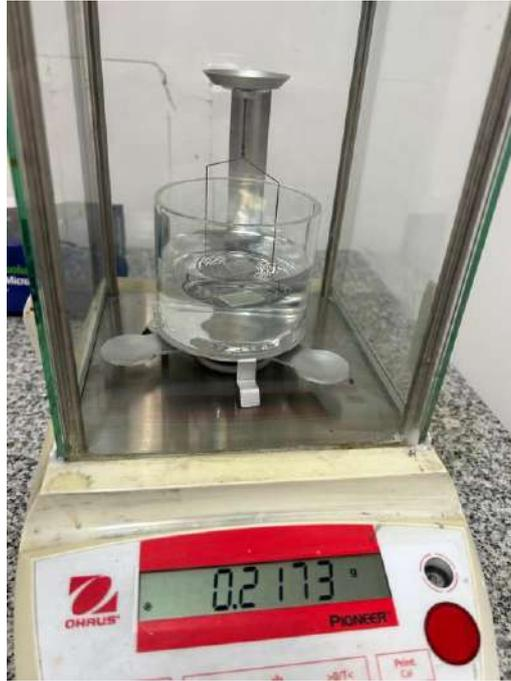
**Figura 3.7.** Arreglo utilizado para los pesajes en seco y mojado
