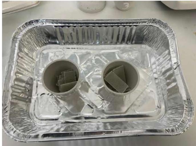
**Figura 3.8.** Muestras de material en crisoles para calcinación.
