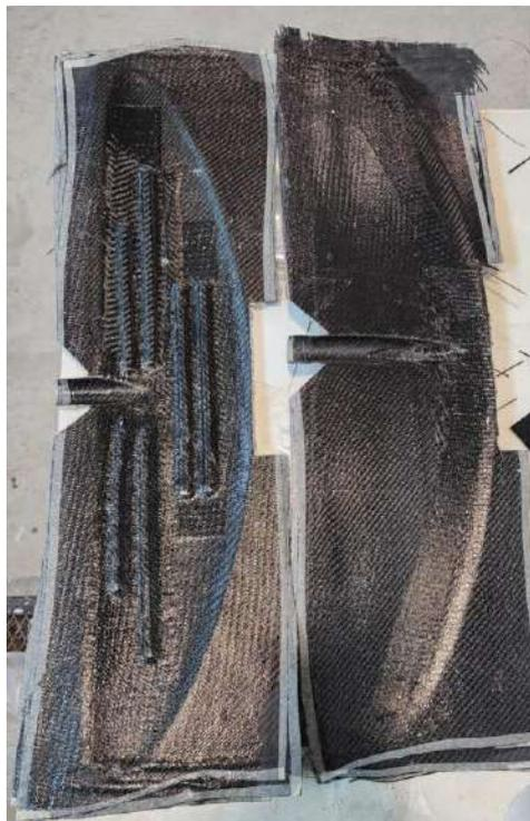
**Figura 5.6.** Ambas caras de la pieza luego del refuerzo por laminado manual.
