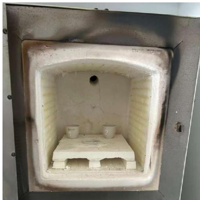
**Figura 3.9.** Mufla utilizada para la calcinación bajo campana.
