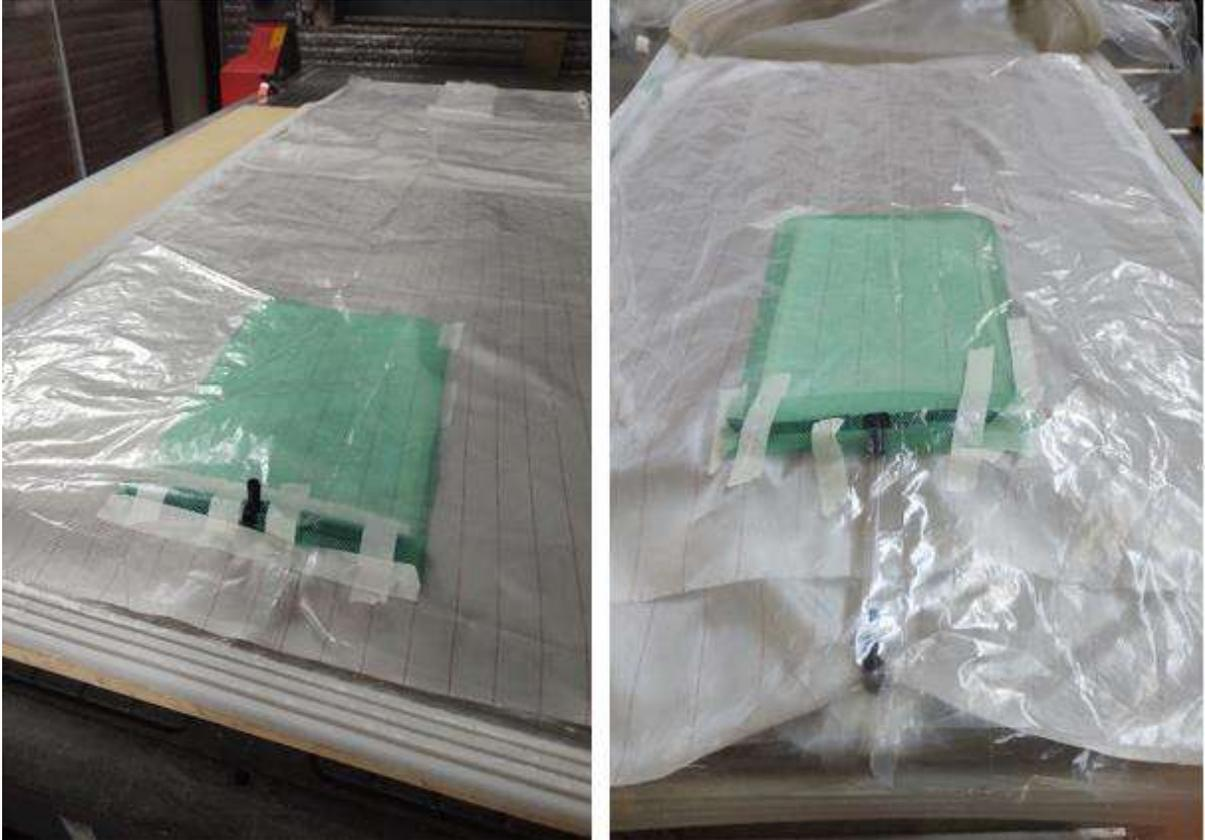
**Figura 3.2.** Disposición de preforma, *peel ply* y *Flow media* previo al cerrado de membrana.
