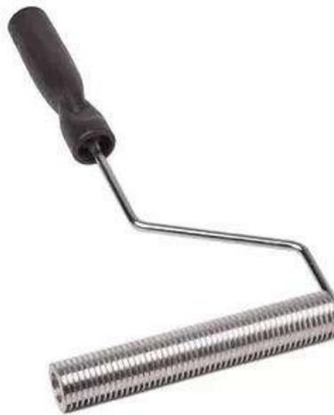
**Figura 3.1.** Rodillo de laminación manual similar al utilizado.
