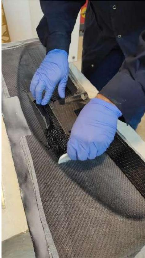
**Figura 5.5.** Laminación manual de refuerzo en zona dañada.
