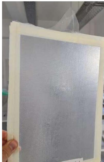
**Figura 3.4.** Placa obtenida post desmolde.
