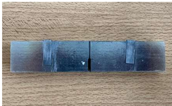
FIGURA 1.23: Probeta de HIPS con superficie metalizada con cromo
