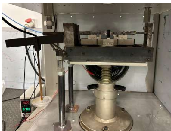
FIGURA 2.1: Dispositivo Hoop-Stress instalado en la máquina instrumentada tipo falling weight
