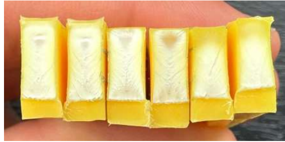
FIGURA 2.12: Superficies de fractura de las muestras de PA12. Los dos fragmentos de la izquierda corresponden a la PA12-1, las del centro a la PA12-2 y las de la derecha a la PA12-3.
