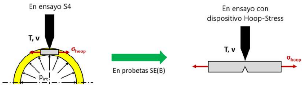
FIGURA 2.3: Idea detrás del ensayo con uso del dispositivo Hoop-Stress
