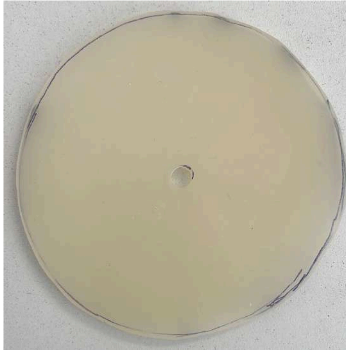
Figura 4.7. Muestra 7: sistema M2,5; procesador ultrasónico con punta; en molde cerrado.
