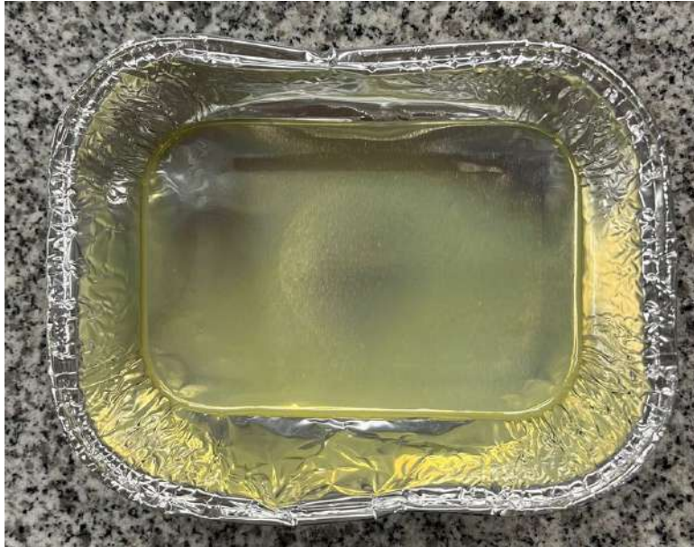
Figura 4.5. Muestra 5: sistema M5S; ultrasonido con baño de agua; en molde abierto.
