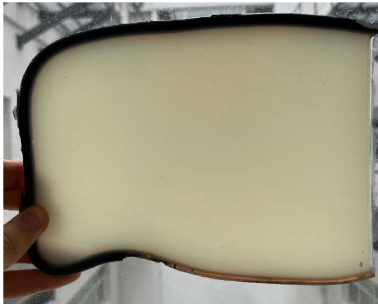
Figura 4.14. Muestra 14: sistema M5A V ; mezclador giroscópico; en molde cerrado.
