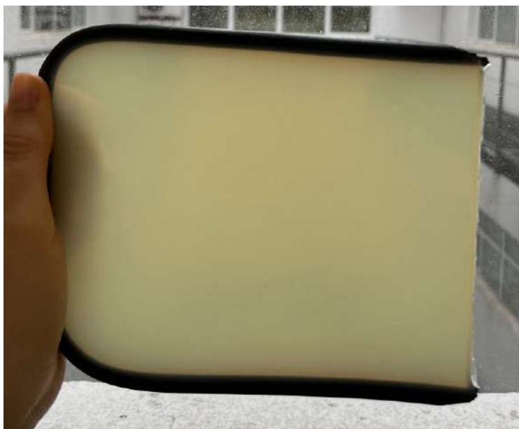
Figura 4.9. Muestra 9: sistema M2,5; procesador ultrasónico con punta; en molde cerrado.
