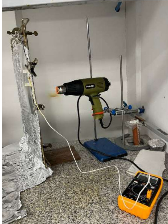
Figura 3.5. Disposición de la técnica de curado con spray.
