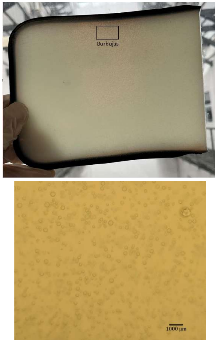
Figura 4.13.a. Muestra 13: sistema M5A; mezclador giroscópico; en molde cerrado. b. Burbujas.
