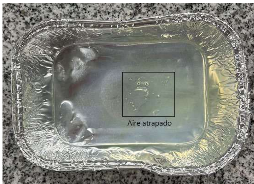
Figura 4.4. Muestra 4: sistema M1,2; ultrasonido con baño de agua; en molde abierto.
