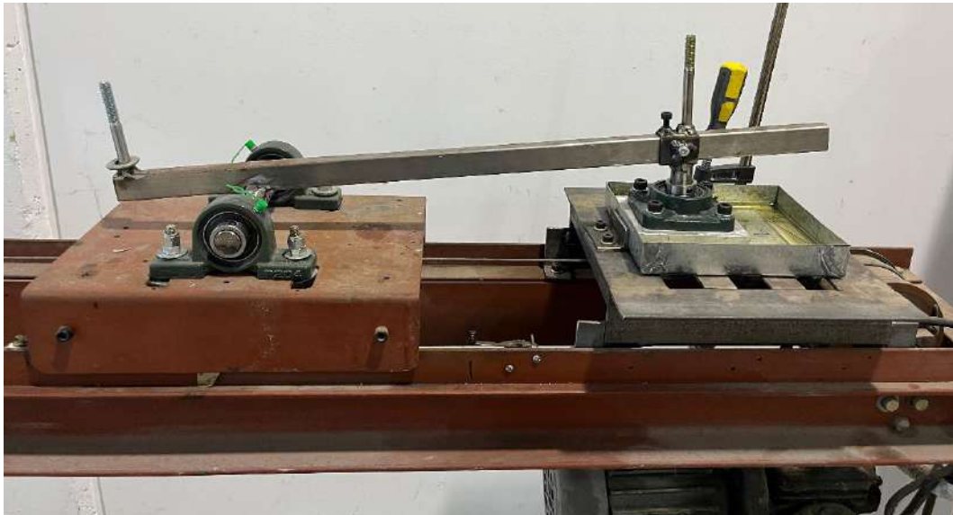
Figura 3.11. Máquina puesta a punto para simular el movimiento del pistón.
