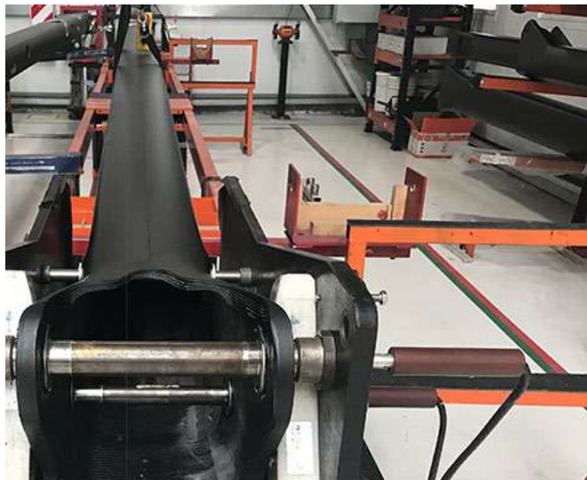
Figura 2.1. Barral pulverizador de material compuesto de resina epoxi con fibra de carbono de la firma King Agro [15].
