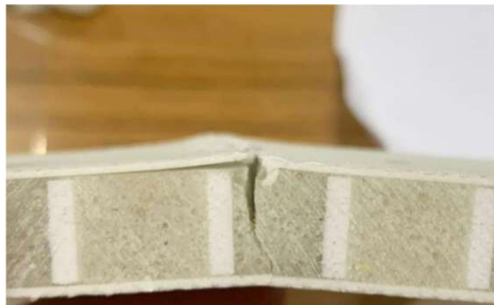
Figura 56. Detalle de rotura de probeta 1 con 4 telas de fibra de vidrio en ensayo de flexión en 3 puntos
