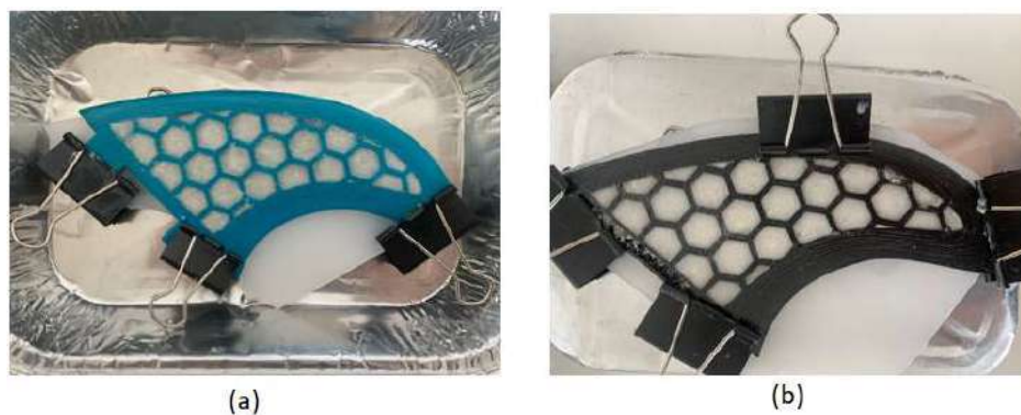
Figura 23. Núcleos de quillas: estructuras tipo “honeycomb” con geometría de quilla rellenos de resina epoxi y polvo de PU: (a) quilla lateral; (b) quilla central.
