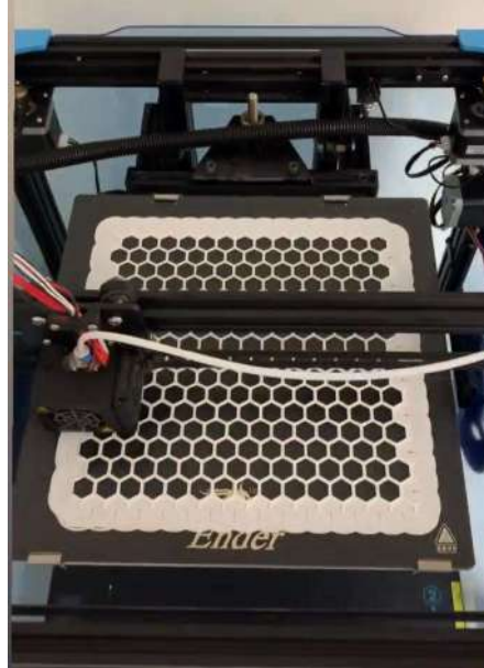
Figura 14. Estructura tipo HoneyComb en proceso de impresión
