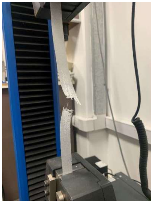
Figura 44. Probeta de 1 tela de fibra de vidrio luego de ser ensayada.
