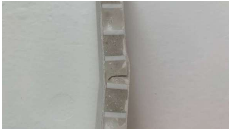
Figura 55. Rotura de probeta 1 con 1 tela de fibra de vidrio en ensayo de flexión en 3 puntos.
