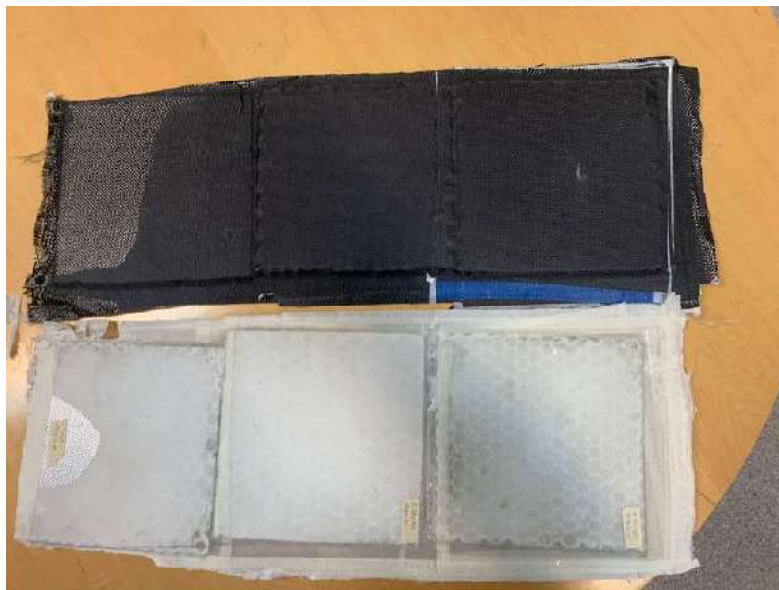
Figura 20. Placas luego de la laminación por infusión por vacío
