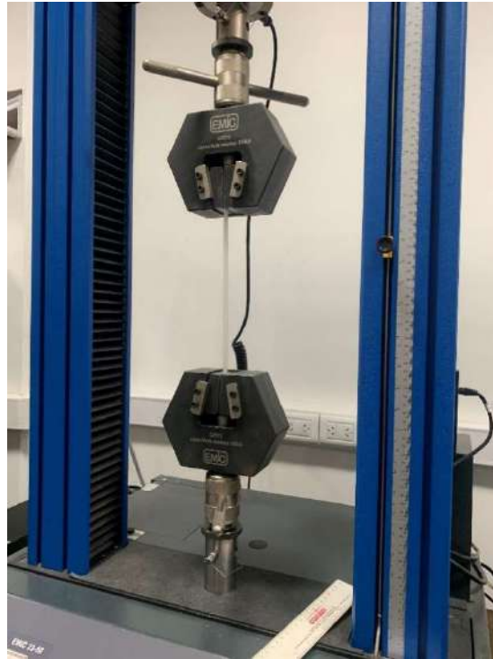
Figura 43. Probeta de 1 tela de fibra de vidrio antes de ser ensayada.
