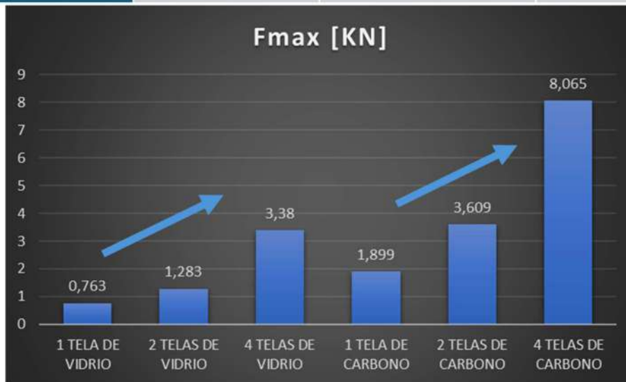
Figura 42. Comparación de valores de fuerza de rotura.
