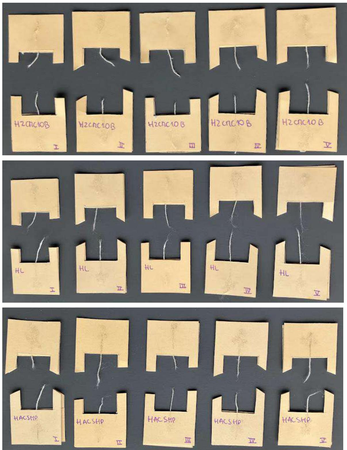
**Figura 37:** Probetas ensayadas para cada combinación hilo/nanocompuesto.
