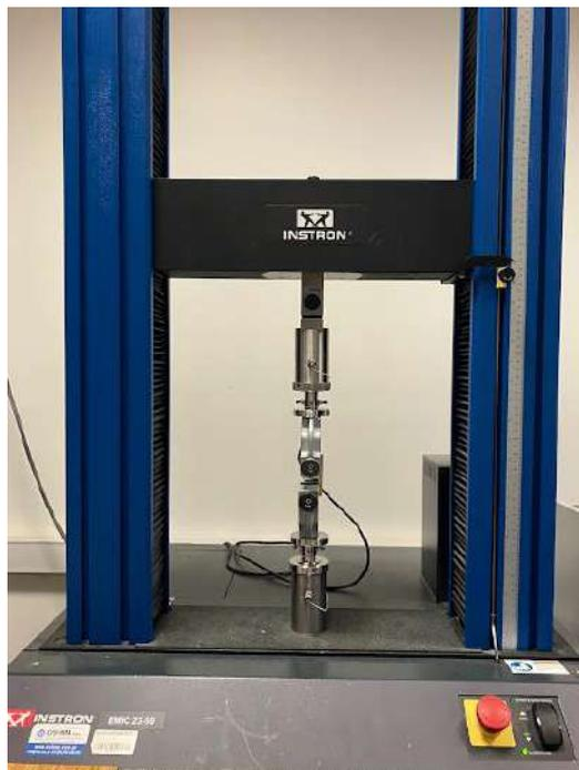
**Figura 14:** Equipo para ensayo de tracción uniaxial Instron EMIC 23-50.
