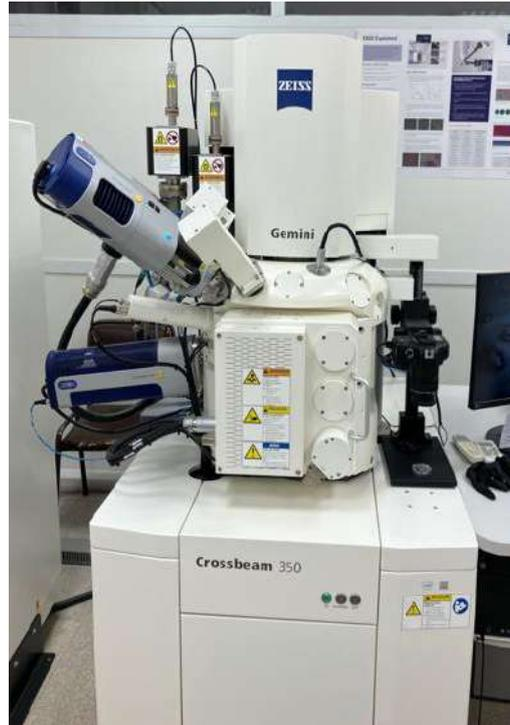
**Figura 16:** Microscopio electrónico de barrido Zeiss Crossbeam 350.
