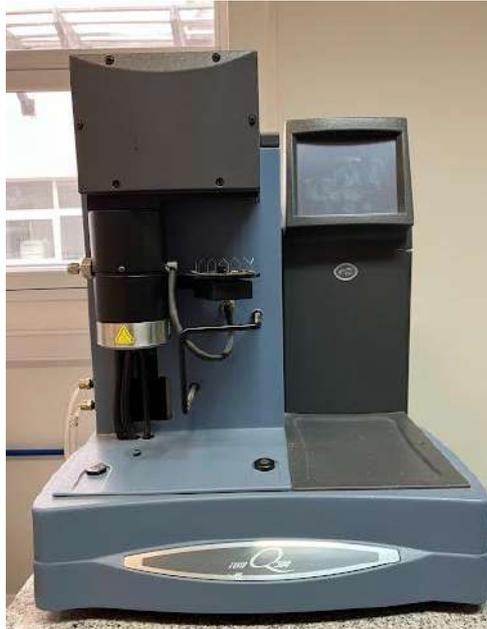
**Figura 10:** Equipo de análisis termogravimétrico TGA-TA Instruments Q500.
