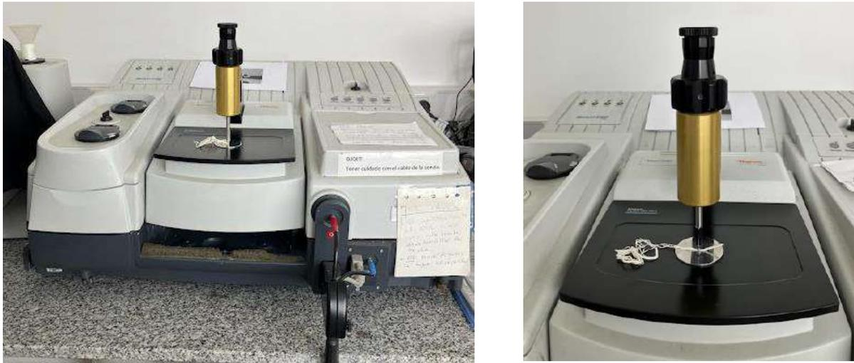
**Figura 13:** a) Equipo FTIR Thermo Nicolet 6700, b) Muestra lista para análisis.
