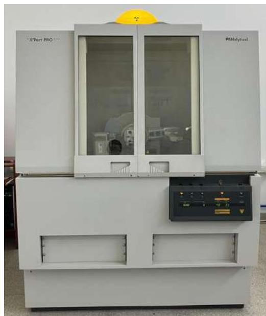
**Figura 11:** Equipo de difracción de rayos X Panalytical X'Pert Pro.
