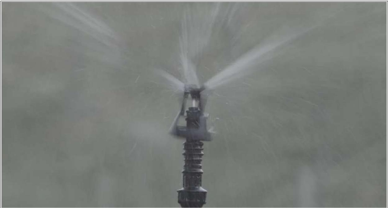
*Figura 7: Cabezal de un aspersor giratorio disparando agua en forma de llovizna.
