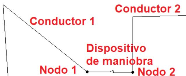
Figura 3.5.7 – Ejemplo de colocación de dispositivo de maniobra: elaboración propia.
