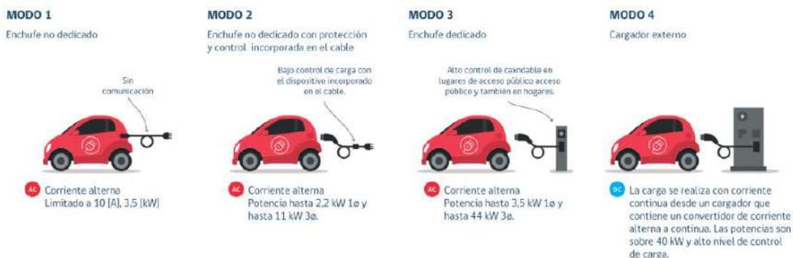
Figura 1.3.1.1.1 – Modos de carga según norma IEC 61851. Fuente: [13]
