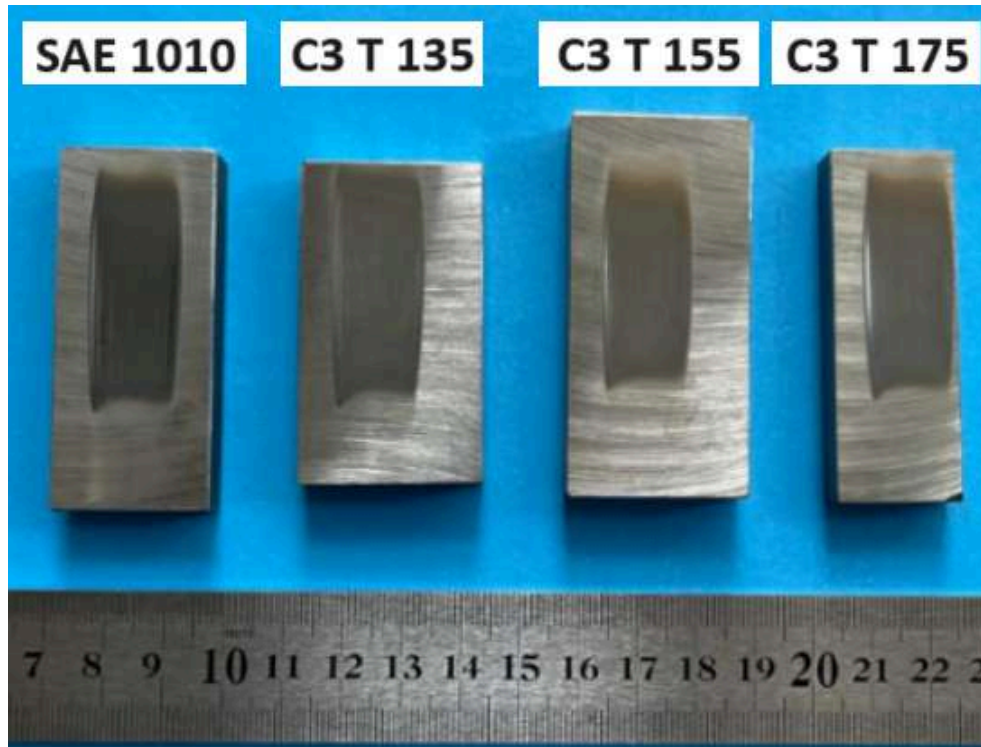
Figura 4.25: Probetas de la colada 3 después del ensayo de abrasión ASTM G65, mostrando las huellas de desgaste.
