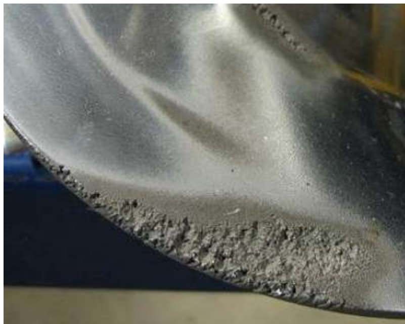
Figura 2.25: Aspecto superficial de una hélice con daño por cavitación.
