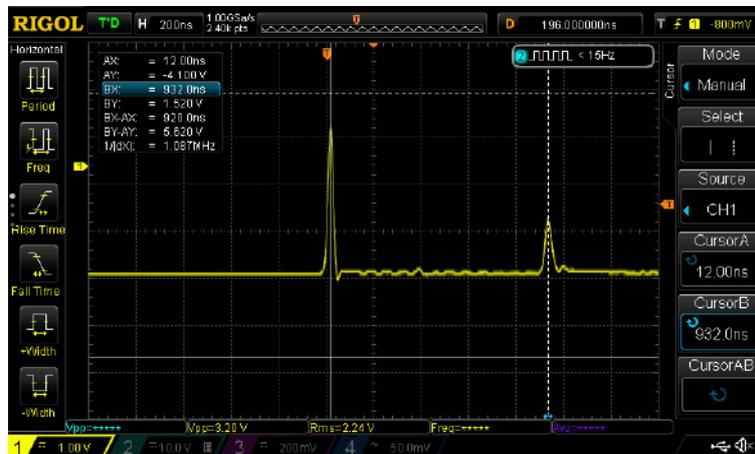
Figura 5.2.2.4 Oscilograma de todo la longitud del cable con Derivador de 2 vías funcionando como empalme recto
