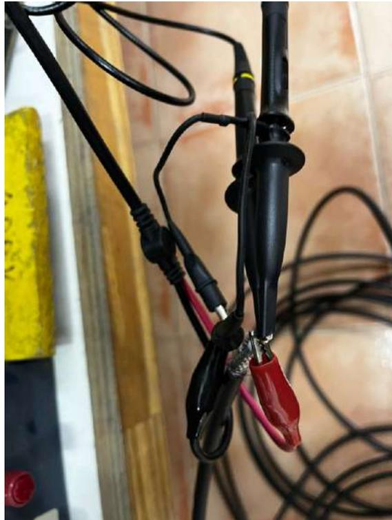
Figura 5.2.4 Vista superior del conexionado del Generador de pulsos, el osciloscopio y el cable coaxil
