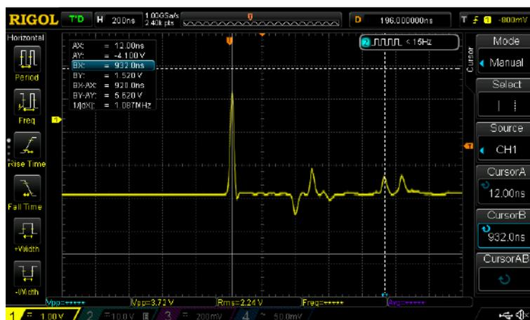
Figura 5.2.4.2 Reflectometría de un empalme de derivación
