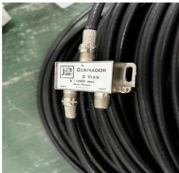
Figura 5.2.2.3 Derivador de 2 Vías funcionando como empalme recto
