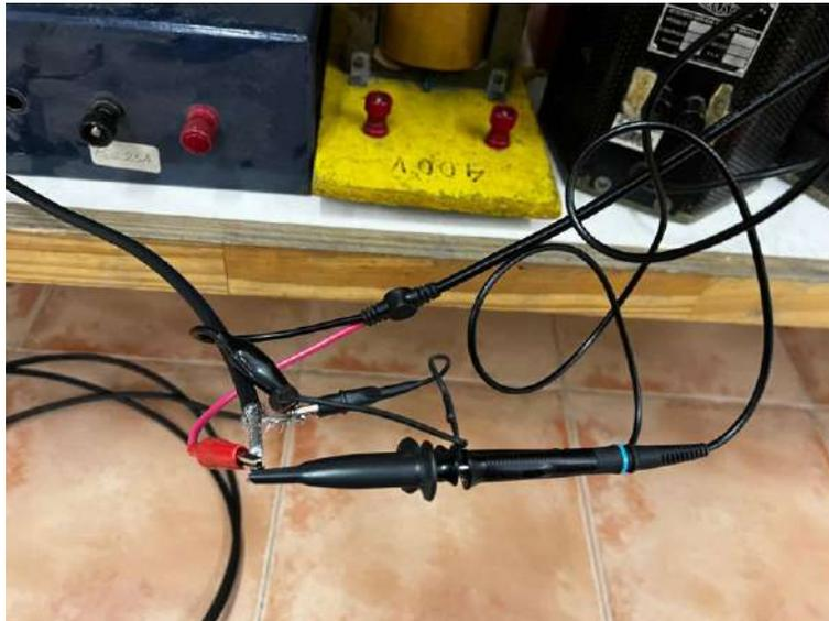
Figura 5.2.3 Conexión del osciloscopio y el generador de pulsos al cable coaxial
