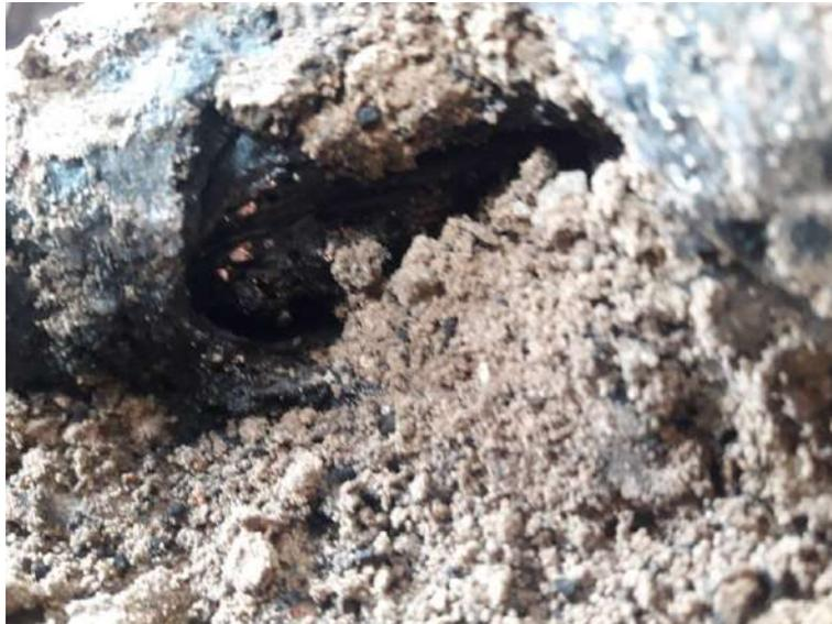
Figura 4.1.7 Daño del cable sufrido por la falla
