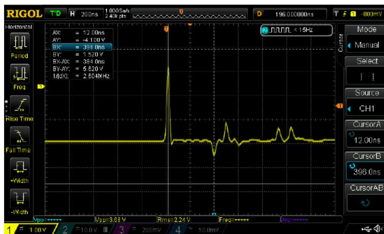
Figura 5.2.4.3 Medición de la reflectometría del empalme de derivación
