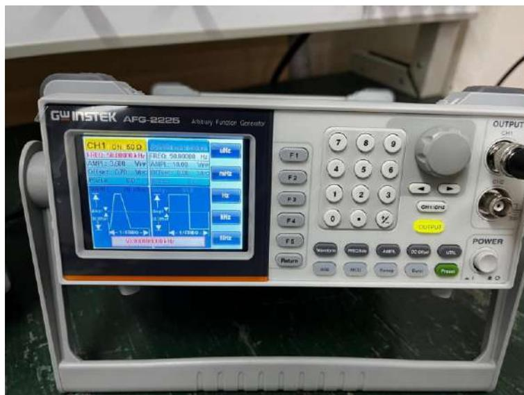
Figura 5.2.5 Generador de pulsos Gw Instek AFG-2225
