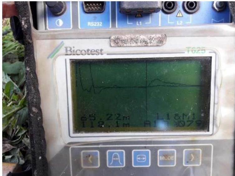
Figura 4.2.2 Reflectometría de fase sana y fase en falla
