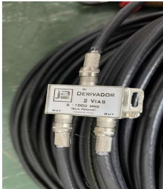
Figura 5.2.4.1 Derivador de 2 vías funcionando como empalme de derivación
