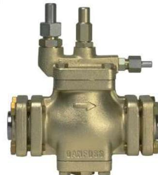
Una válvula tipo PM 3 se instalará en la línea de retorno general de bodegas y dispone de dos estados: uno es la de regular la presión para una temperatura de evaporación de  $-25\text{ }^{\circ}\text{C}$ , reduciendo de esta manera un elevado salto de temperatura que ocasionaría un prematuro bloqueo del aletado de las serpentinas por acumulación de hielo y el otro es de apertura total. Estos dos estados son gobernados por medio de un solenoide.
