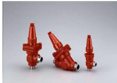
Las válvulas REG están equipadas con caperuza y tienen un asiento interno que permite el cambio del vástago de sellado cuando la válvula está aún bajo presión.
