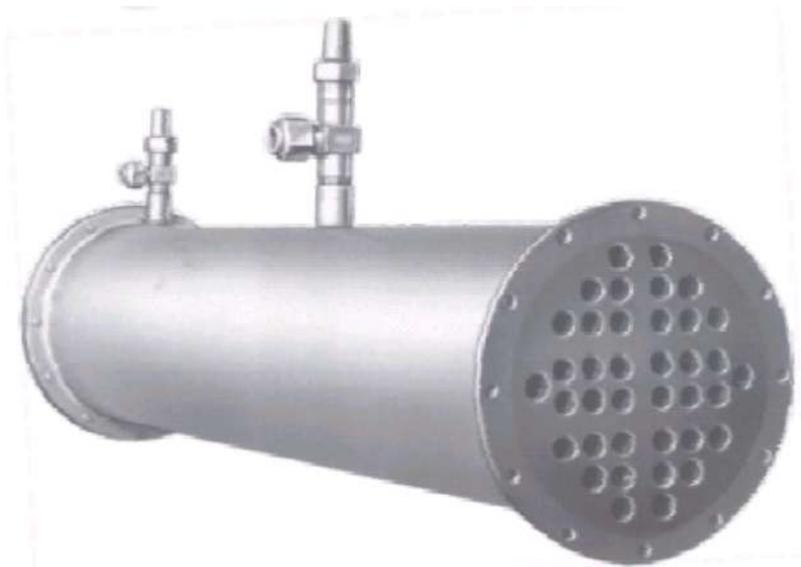
El equipo condensador, es el encargado de transformar el refrigerante en forma de vapor proveniente de los compresores, en líquido para luego ser almacenado en el recipiente de líquido. Esta transformación es lograda gracias al intercambio de calor entre dos fluidos, en este caso particular el refrigerante con agua de mar.
