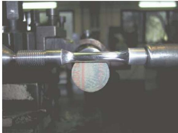
Se usó una extensión para alejar la probeta del plato y así poder trabajar más cómodamente. La misma fue calibrada mediante un comparador.
