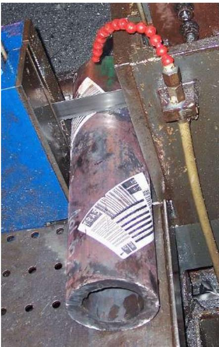
El primer paso es cortar el tubo (que puede ser de recalque) en tiras de 20 mm de ancho con el serrucho o en MAZAK, según disponibilidad. Si el pedido de ensayo es escalonado y Método A, el tubo es primero dividido en el serrucho, destinando 350 mm al escalonado y 150 mm al Método A.
