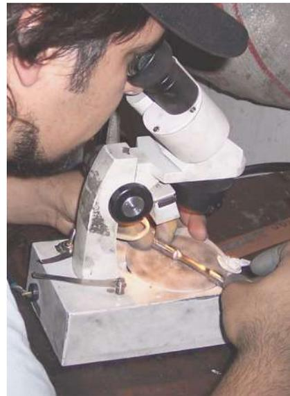
Ante la presencia de defectos se debe continuar con pasadas longitudinales para no rayar la probeta. Puede utilizarse un utensilio de madera con punta plana, para hacer más localizada la pasada.
