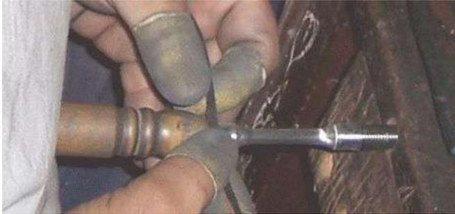
A continuación se prosigue con las pasadas longitudinales. Este trabajo se realiza trabando la probeta en forma perpendicular al operario y haciendo pasadas
