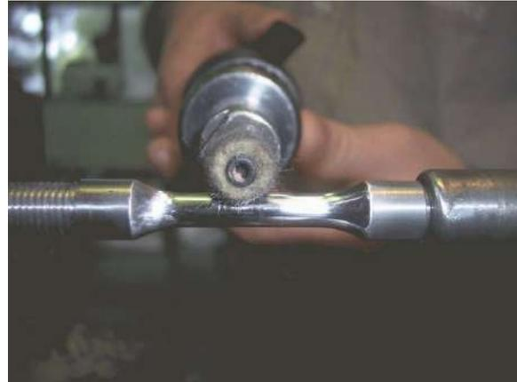
El movimiento del dispositivo se esquematiza en la figura. La turbineta gira a bajas vueltas (3500 rpm) para evitar el desprendimiento de pasta por fuerza centrífuga, y se desplaza de extremo a extremo de la zona calibrada a razón de 50 mm/s. Por su parte la probeta se mantiene quieta, y luego de 6 pasadas del dispositivo de fieltro, es rotada 25° antihorarios desde la contrapunta.
