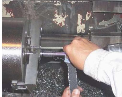
Con una sierra manual se corta y separa la probeta, puliendo el relieve resultante en la lijadora. El trozo de muestra que queda en la mordaza es enviado junto con la viruta, al contenedor de desperdicios metálicos.
