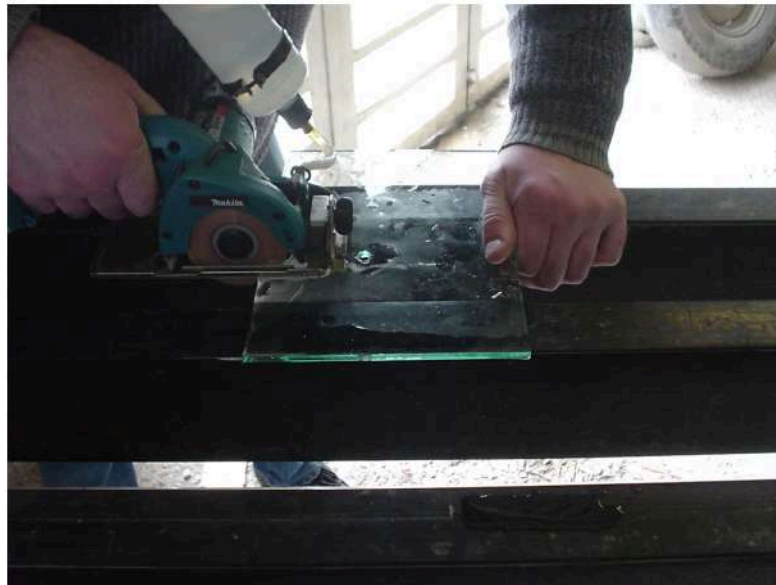
Proceso de aserrado de la plaquita de vidrio
