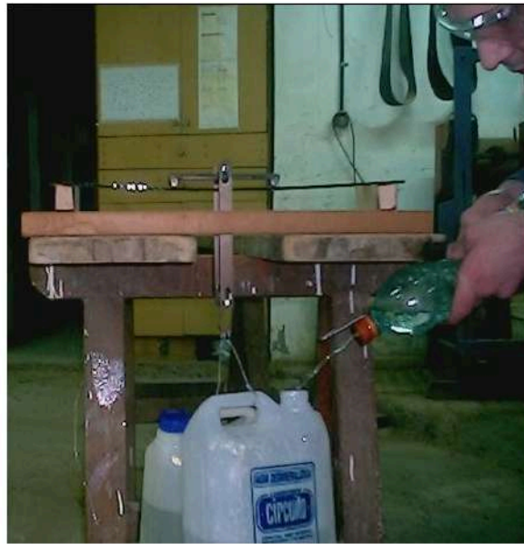
Agregado de líquido en el ensayo de 4 puntos
