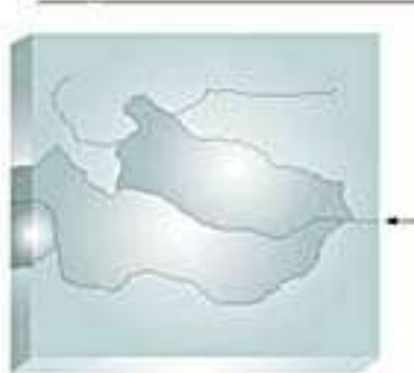
FIGURA 3: fractura de alta tensión
