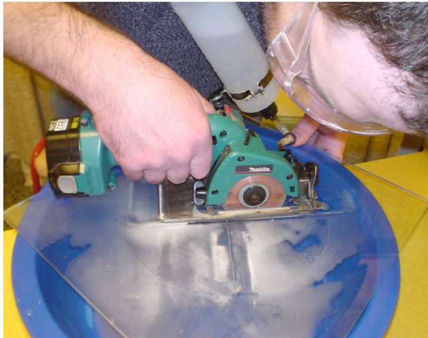
Cortes perpendiculares con la sierra
