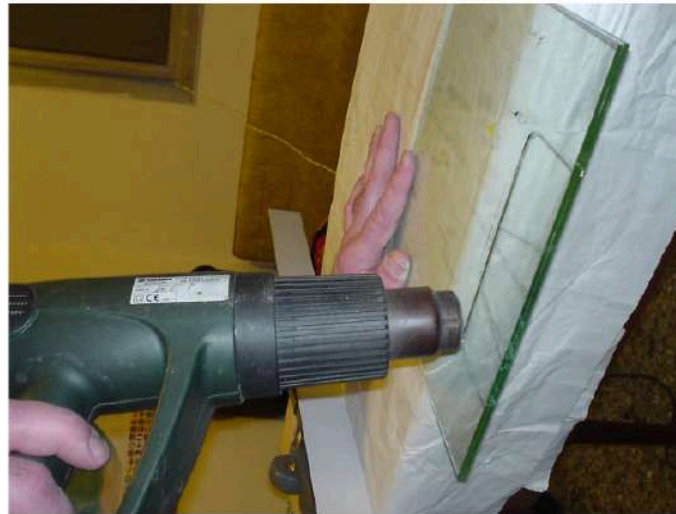
Proceso de calentado para la extracción del pedazo central
