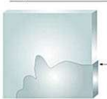
FIGURA 2: fractura de baja tensión
