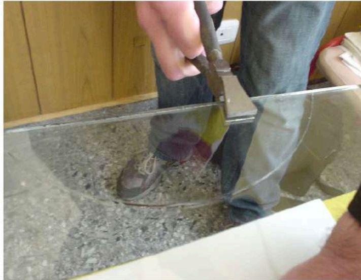
Traccionado para finalizar el corte de smicirculo
