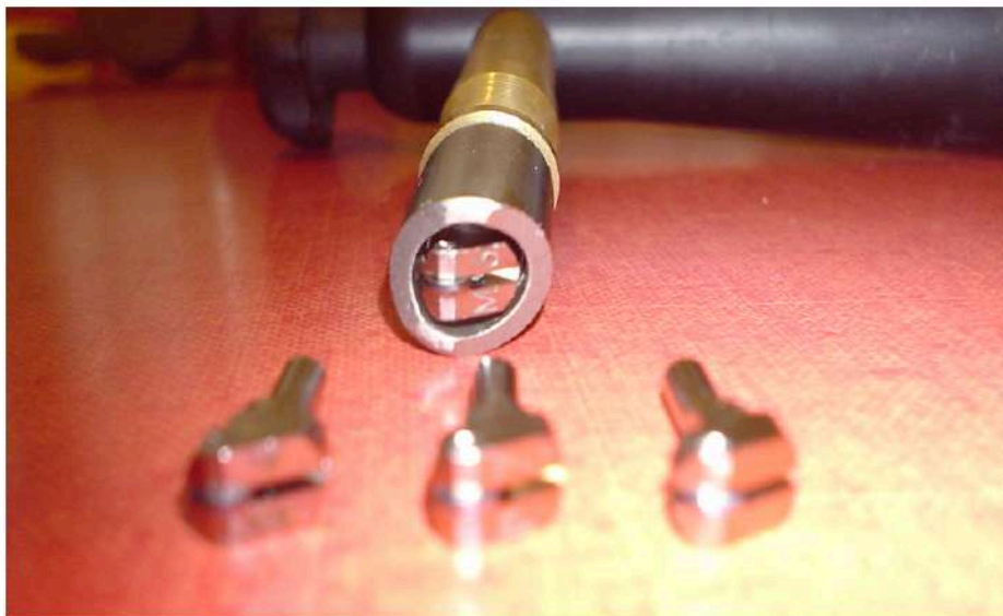
Cortavidrios y sus diferentes rulinas con sus soportes
