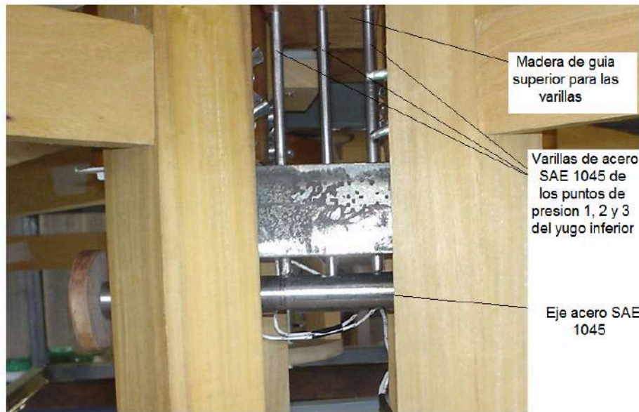
Madera de guía para las varillas de los puntos de presión
