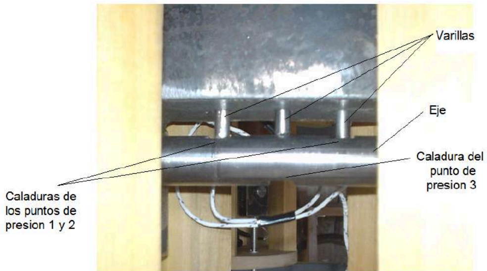
Caladuras del eje para seleccionar los puntos de presión
