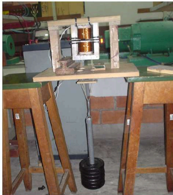
Disposición de los electroimanes en el ensayo de corriente continua
