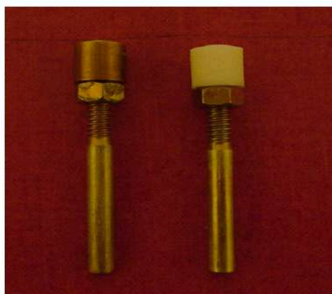
Pernos con improntas de bronce y teflón respectivamente la tuerca sirve para regular la altura y de base para soportar los esfuerzos.
