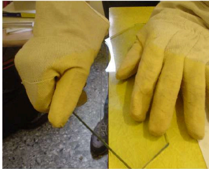
Disposicion para la apertura del corte en triangulo
