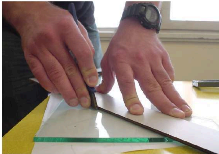
Marcado del corte de la placa de vidrio en triángulo
