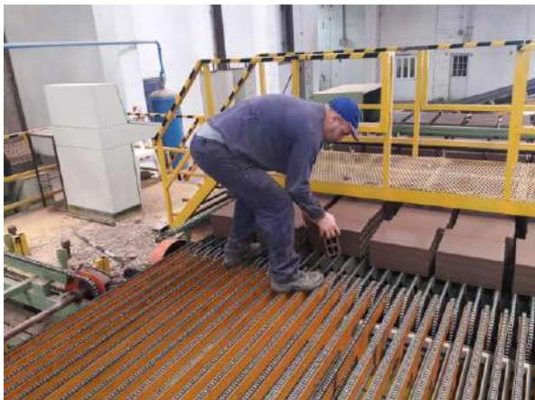
Foto 3.13 “Descarte de ladrillo defectuoso sobre mesa de cadenas”-Fuente: Propia
