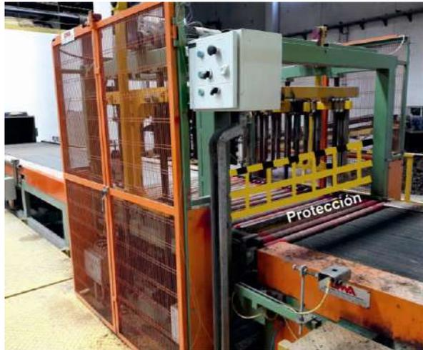
Foto 3.25 "Protección lateral en cortadora"-Fuente: Propia
