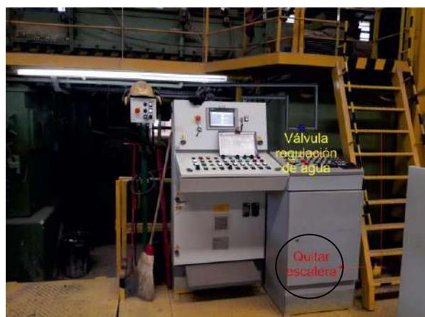
Foto 3.23 "Válvula de regulación de fácil acceso"-Fuente: Propia
