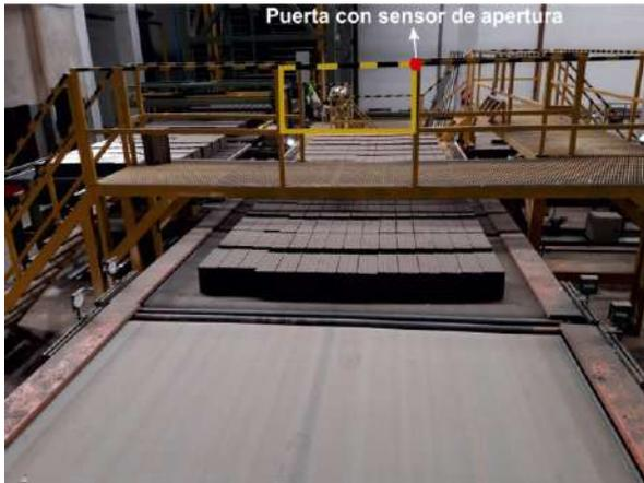
Foto 3.29 "Sensor de seguridad en puerta"-Fuente: Propia
