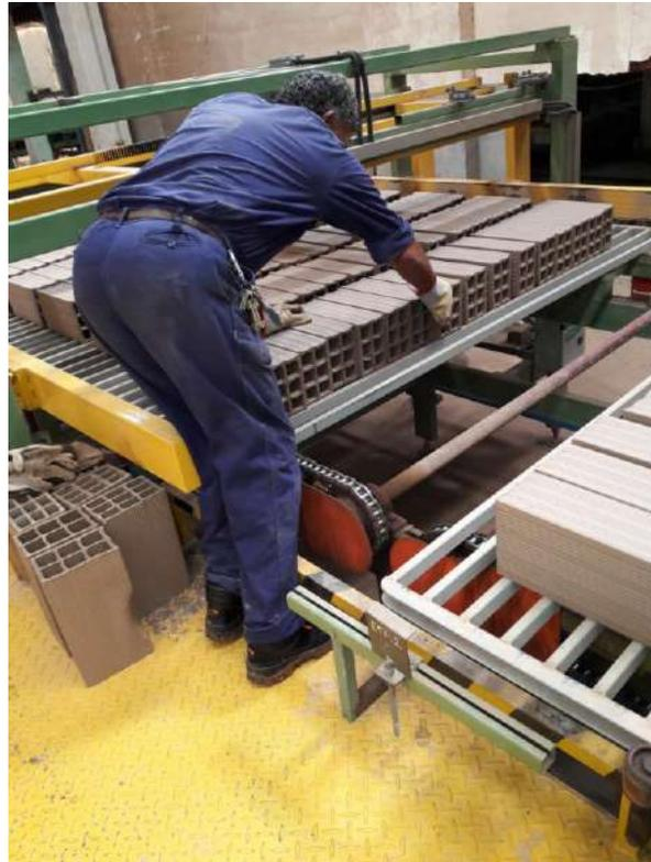
Foto 3.20 “Descarte de ladrillo fisurado”-Fuente: Propia
