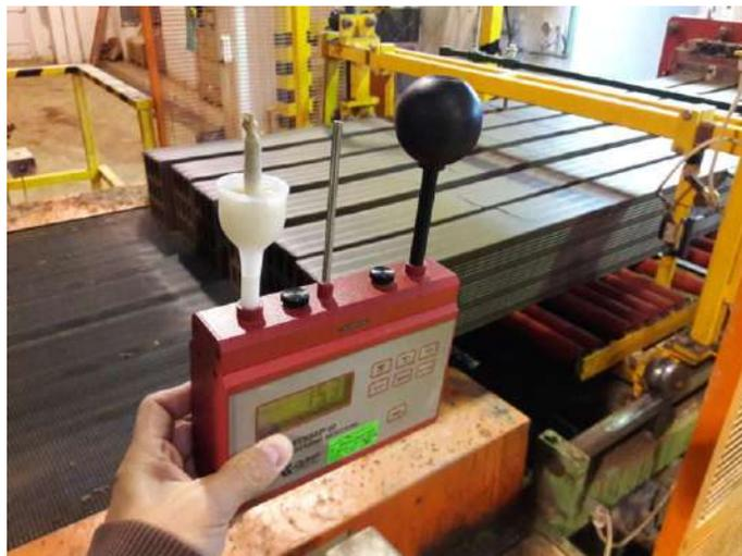
Foto 3.39 "Medición de carga térmica en extrusora" - Fuente: Propia
