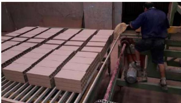
Foto 3.18 "Operario limpiando la parte superior de los ladrillos"-Fuente: Propia
