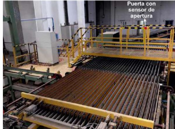
Foto 3.27 "Sensor de seguridad en puerta"-Fuente: Propia
