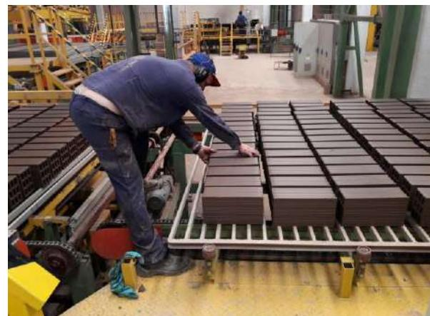
Foto 3.14 “Descarte de ladrillo defectuoso desde plataforma”-Fuente: Propia
