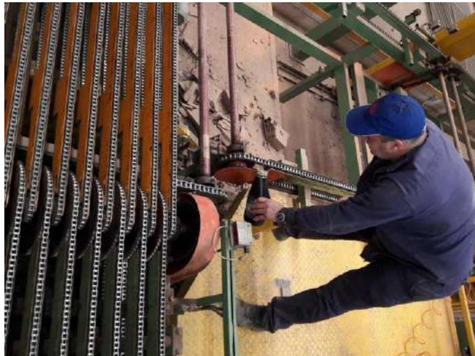
Foto 3.15 “Lubricación de cadenas con maquinas en funcionamiento”-Fuente: Propia
