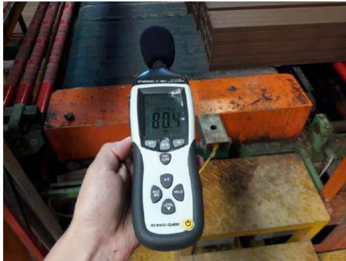
Foto 3.31 "Medición de nivel sonoro en el puesto de trabajo del extrusorista" - Fuente: Propia
