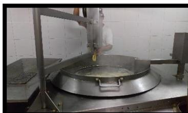
*Ilustración V.- Máquina freidora de 120 litros, zona de producción de churros*
