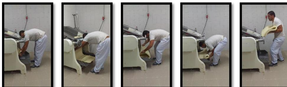
Ilustración XXI.- Levantamiento de masa en la etapa de sobado en la fabricación de pastas
