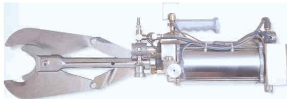
Figura XXIV- Pinza de amputación de patas traseras. Fuente: [www.refin.com.ar](http://www.refin.com.ar), catálogo
