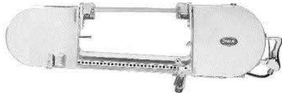
Figura XXIX - Sierra seccionadora de res
