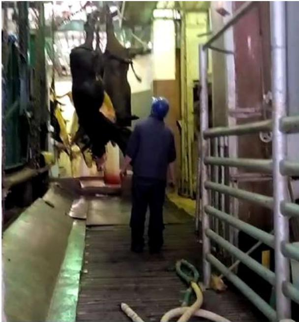
Figura X - Pasillos de salida con manguera en el piso obstaculizando el paso.
