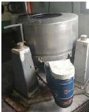
Figura 6 - Máquina Centrifugadora sin protección
