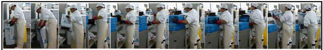
Figura C9: Ciclo trabajo del envasado en caja master – carga de la caja
