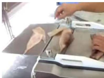
Figura 3: Peladora de Calamar – (Procepez, (2012) Peladora de calamar) ( https://www.youtube.com/watch?v=qI5fISgLSsEM )
