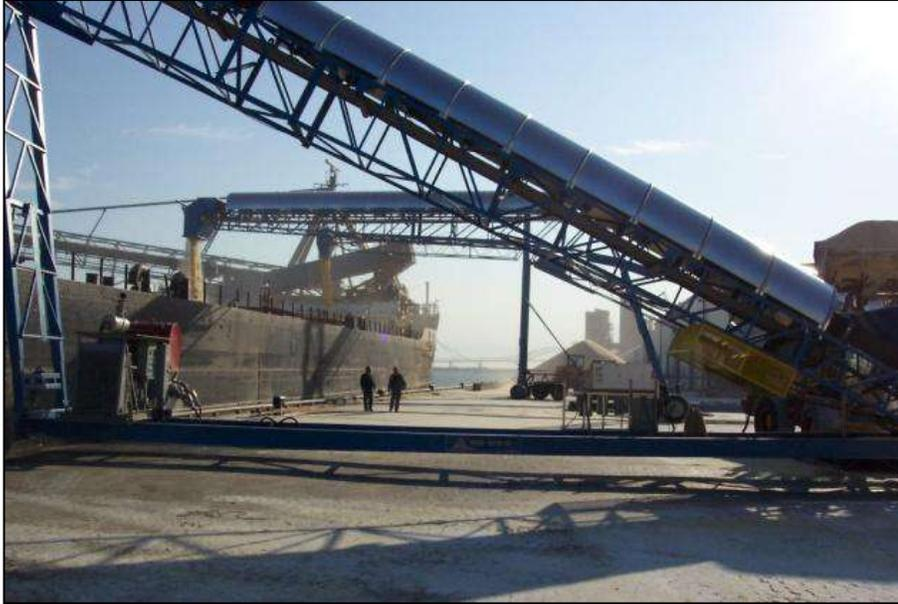
IMAGEN 13 - Modelo de protección de cinta existente – Fuente [www.daconv.com](http://www.daconv.com)
