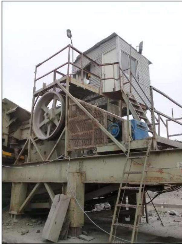
IMAGEN 7 - Mal estado de las barandas acceso a cabina de control - Fuente propia
