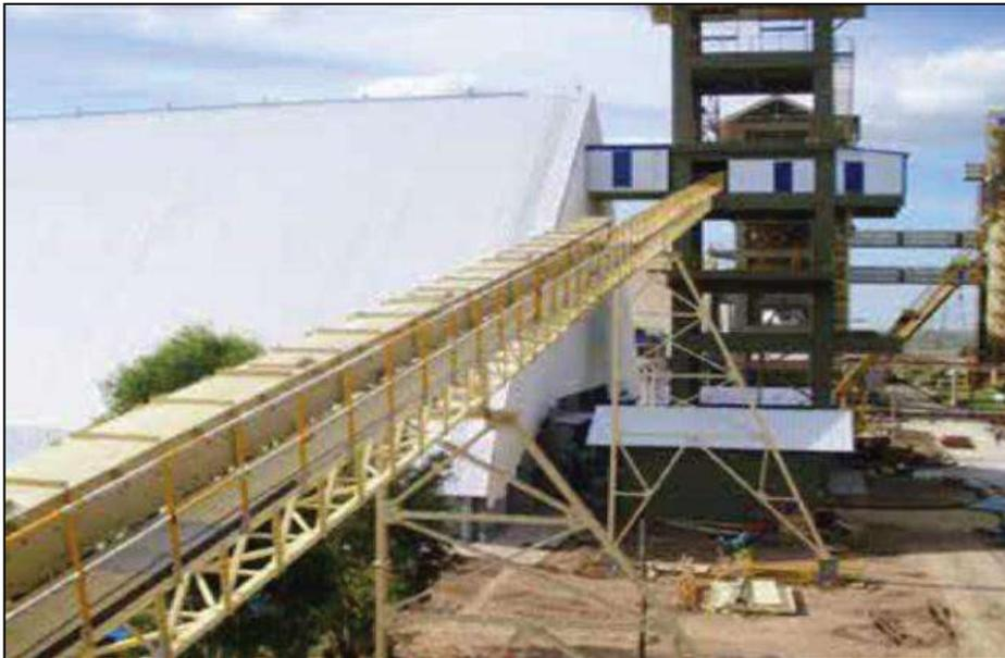
IMAGEN 14 - Modelo de protección de cinta existente – Fuente [www.metalmxsrl.com.ar](http://www.metalmxsrl.com.ar)
