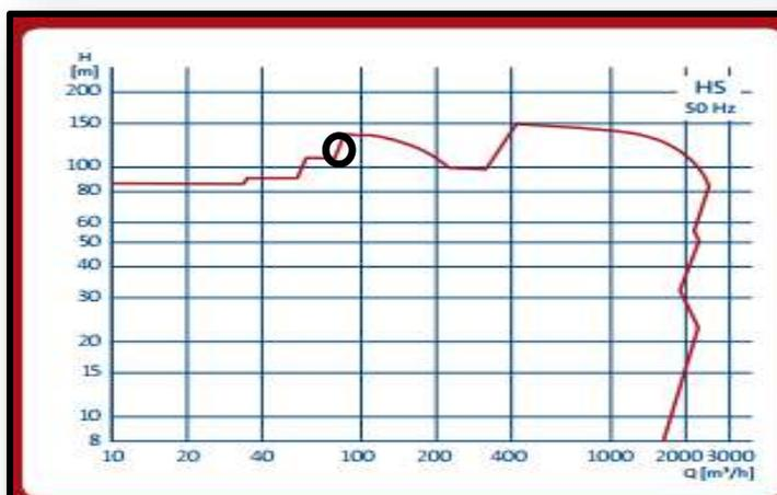
Imagen 14. Rendimiento de las Bombas de Cámara Partida HS/AE de Grundfos
