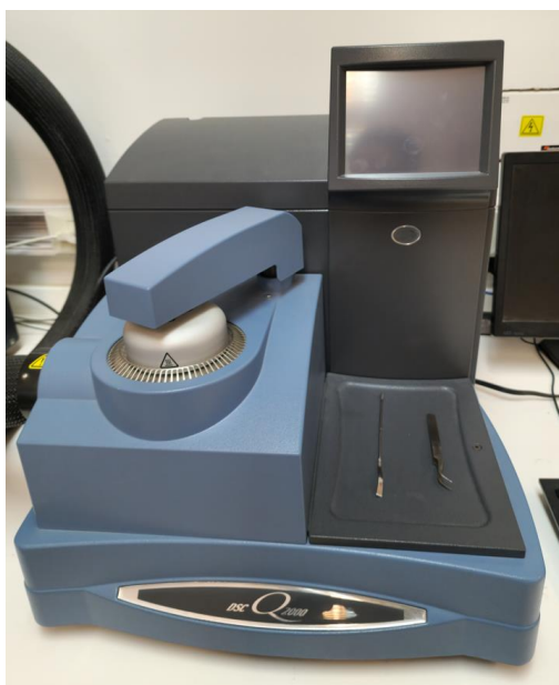
Figura 2.20. DSC. Calorímetro diferencial de barrido.
