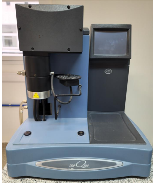
Figura 2.21. TGA. Equipo de análisis termogravimétrico.
