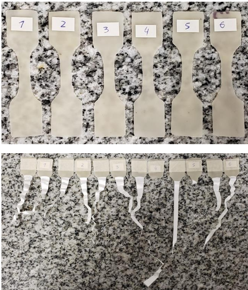
Figura 2.27. Probetas de tracción uniaxial antes y después de ser ensayadas.
