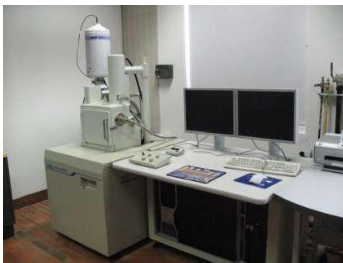
Figura 2.25. Microscopio electrónico de barrido JEOL JSM-6460 LV.
