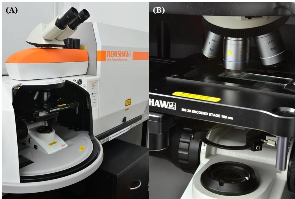
Figura 2.15. (A) Microscopio Confocal Raman Renishaw in-Via Reflex. (B) Mesa del microscopio y acoplamiento de la muestra.
